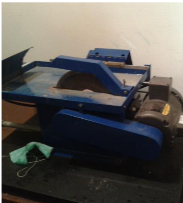
Figura 12. Cortadora de sierra de diamante utilizada para el corte de conchas de mejillón. Los cortes se realizaron en el Lab. De Esclerocronología, Ecología y Pesquerías de la Zona Costera (CICESE) a cargo del Dr. Luis E. Calderón Aguilera.
