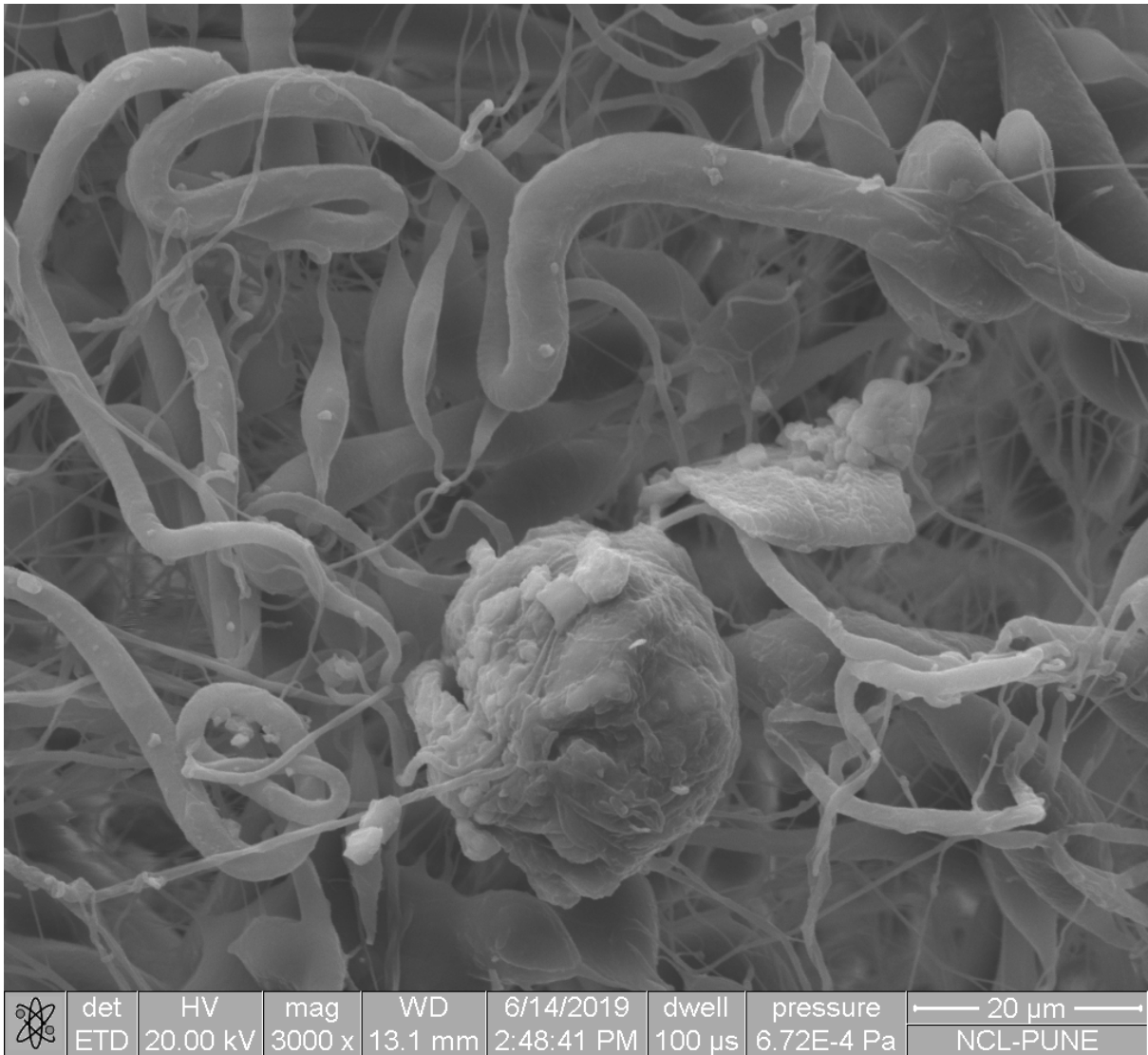
Figura 24. Micrografías SEM de nanofibras de PCL/NCIM2499-5 (3,000 x).
