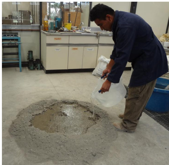
Figura 27.- Adición del agua a la mezcla
