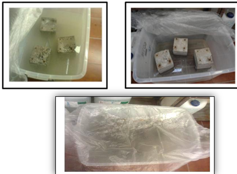
Figura 30.- Acondicionamiento de probetas de concreto reforzado
