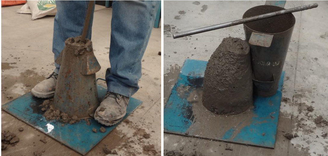
Figura 28.- Prueba de revenimiento
