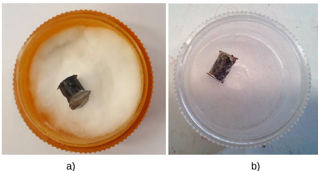
Figura 72.- a) Muestra de acero antes del análisis de composición química y b) Muestra de acero al finalizar el análisis de composición química
