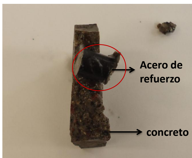
Figura 70.- Muestra la apariencia del acero extraído de la probeta N1 (protegido catódicamente)
