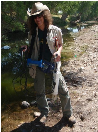
Figura 10 Medidor de múltiples parámetros fisicoquímicos Hydrolab Scout 2.
