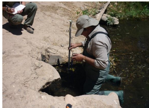
Figura 13 Medición de la velocidad de corriente para determinar gasto.
