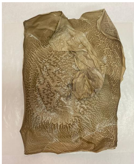
Figura 13.- Película polimérica seca de acetato de celulosa con nanopartículas de sulfuro de plata.
