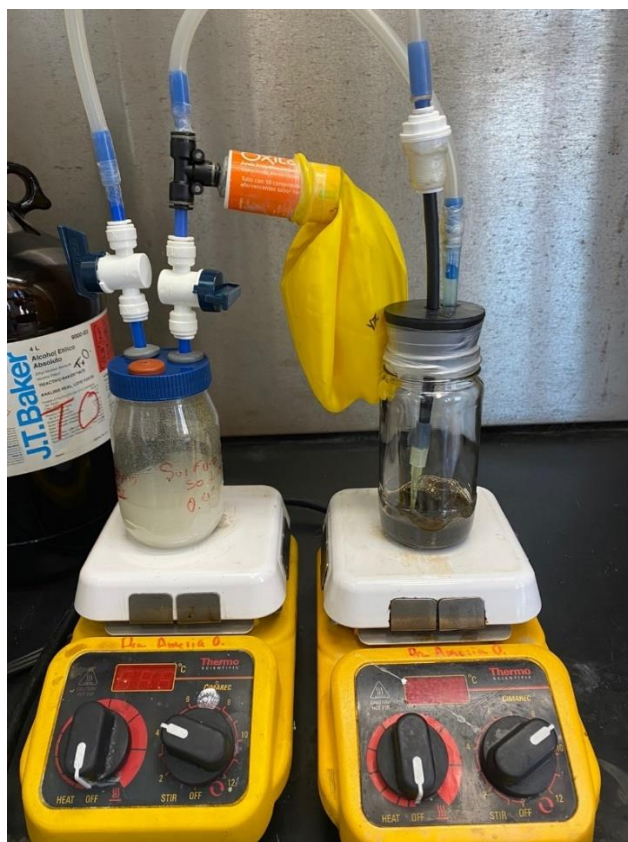
Figura 11.- Reacción de sulfurización entre el \text{H}_2\text{S} y los iones de plata (solución oscura).
