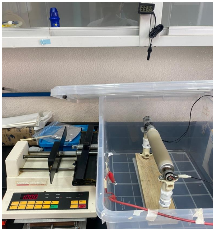
Figura 14.- Representación esquemática de la producción de nanofibras por electrohilado.
