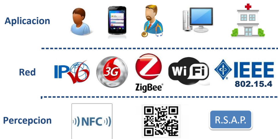
Figura. 3 Arquitectura basada en capas del IoT
