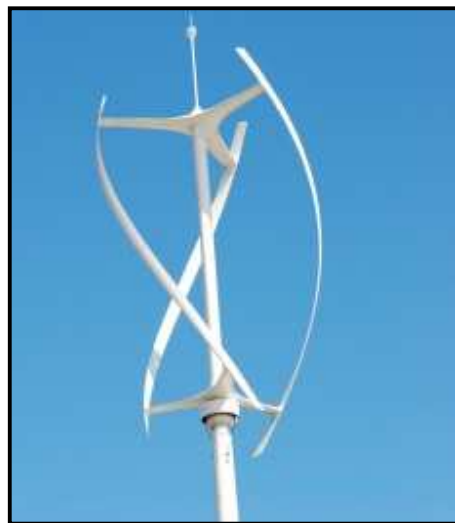
Figura 1.10 Aerogenerador de eje vertical.
