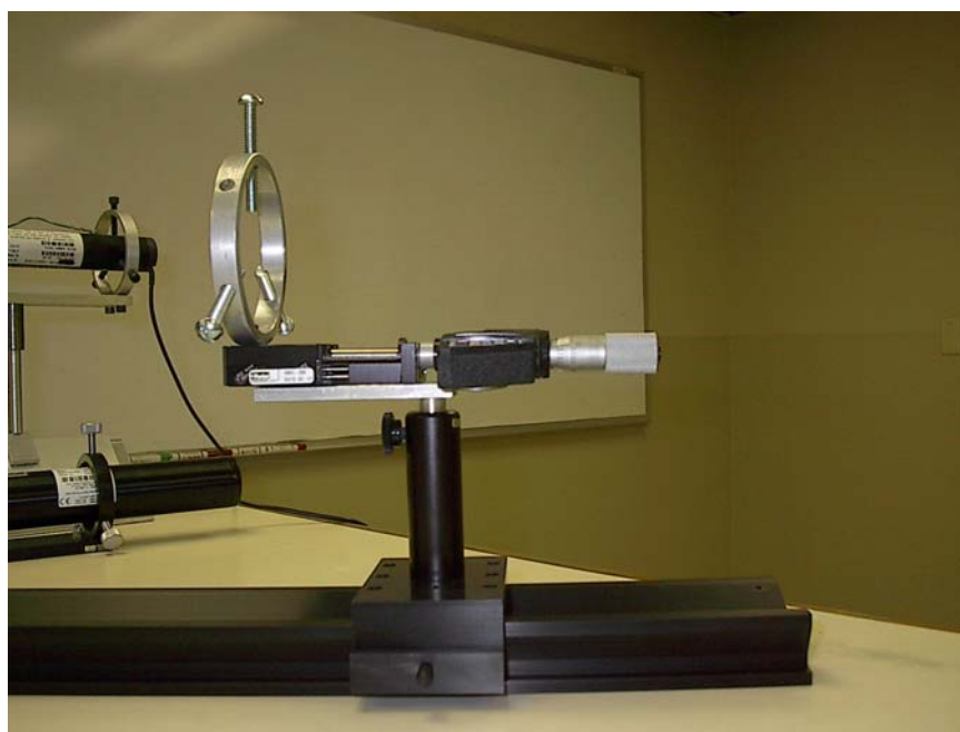
Fig. 4.3. Mecanismo para el desplazamiento micrométrico y aro para sujetar la lente.
