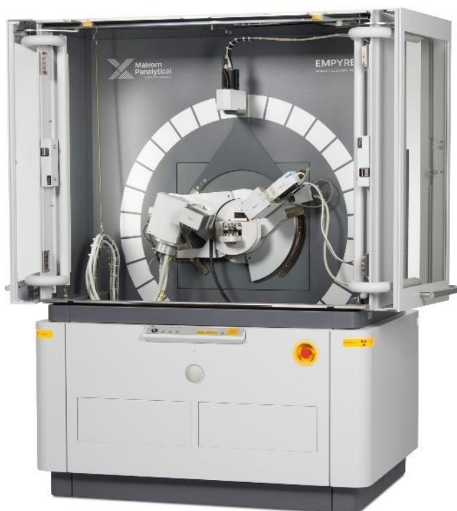
Figura 4.24. Difractómetro Panalytical Empyrean. Equipo utilizado para estudiar la cristalinidad de las películas depositadas mediante sputtering y PE-ALD mediante su configuración de haz rasante.
