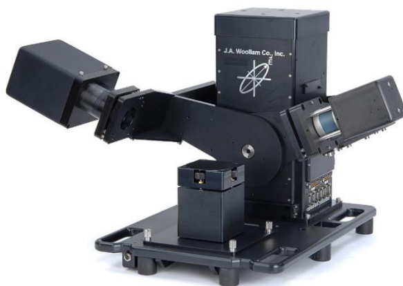
Figura 4.19. Instrumento J.A. Woollam M-2000U. Elipsómetro espectroscópico de ángulo variable adecuado para caracterizar películas dieléctricas, orgánicas, semiconductoras y películas metálicas delgadas.
