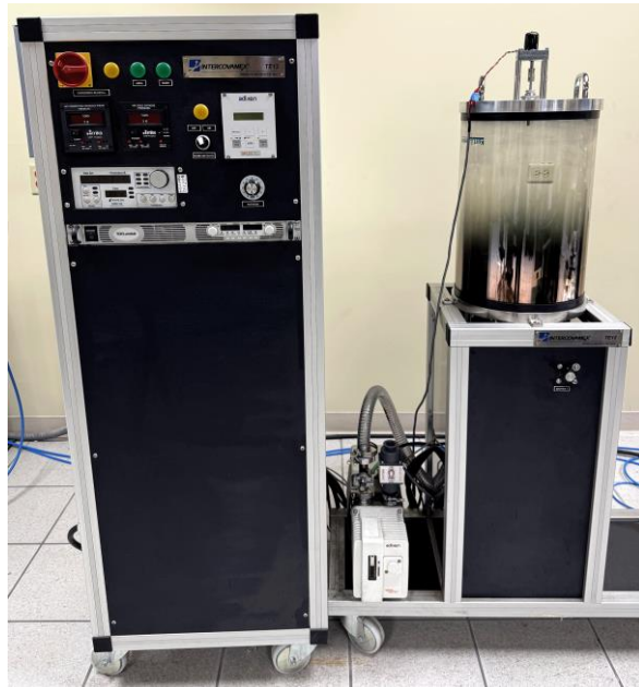
Figura 4.15. Equipo de Evaporación Térmica Intercovamex TE12. Equipo de evaporación térmica utilizado para el depósito de películas metálicas.
