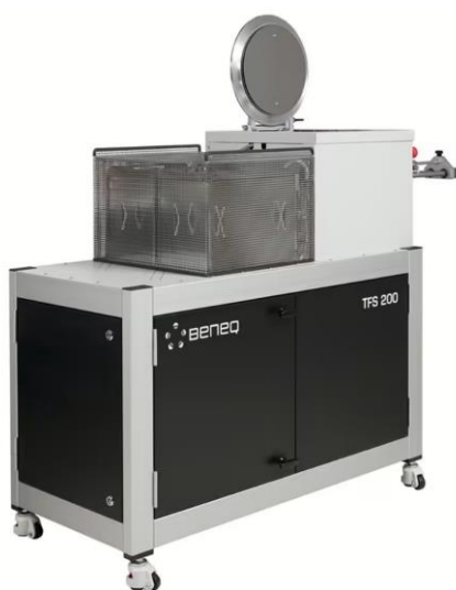
Figura 4.10. Equipo BENEQ TFS 200. Equipo ALD automatizado utilizado para la síntesis de películas delgadas de ZnO, cuenta con configuración ALD-Térmico, PE-ALD con configuración de plasma remoto y directo.
