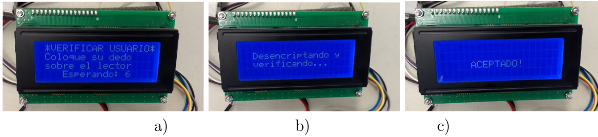
Figura 5.10: Verificación al usuario: a) al presionar el sw2 se debe colocar el dedo registrado del usuario en lector de huellas, b) el microcontrolador descripta la plantilla biométrica y envía template a lector de huellas y c) se realiza la verificación del usuario y permite el acceso al sitio restringido.
