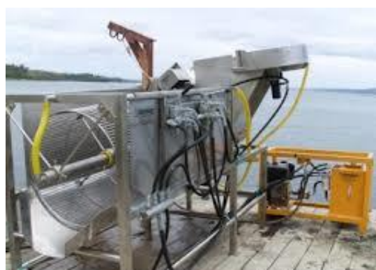
Imagen 20 Maquina para lavar y desgranar (separar) mejillón.
