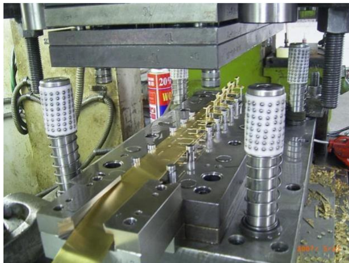
Figura 2. 2 Troquel progresivo de 10 etapas para alta producción. Nótese que las guías ya no emplean bujes sino sistemas antifricción. Fuente [35]
