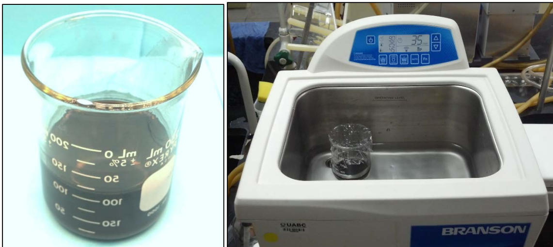
Figura 19. Mezcla de NFC-COOH en solución de sal de hierro.
