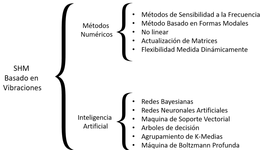
FIGURA 1.1: Diagrama de métodos basados en vibraciones en sistemas de SHM.
