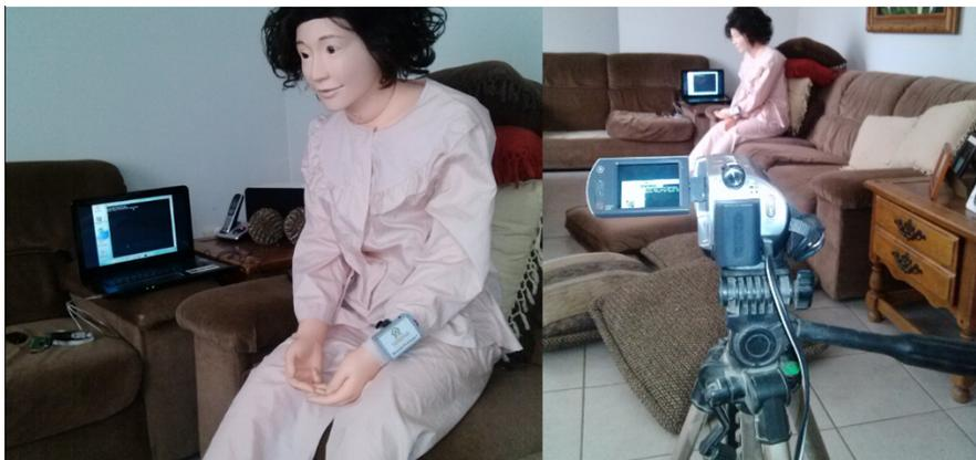
Figura 6.2: Escenario para probar detección de caídas, usando maniquí.
