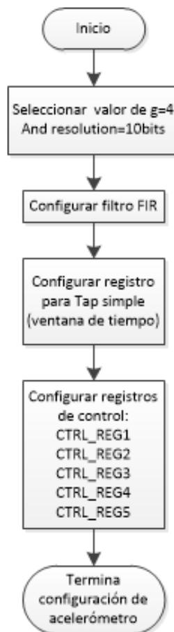
Figura 5.24: Proceso de inicialización de acelerómetro
