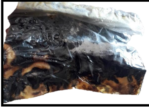
Figura 11. Fotografía de prueba 2 pasado 120 días dentro de una bolsa plástica de cierre hermético parcialmente abierto.
