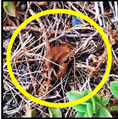
Figura 6. Resultado al mes de la prueba de biodegradabilidad del plástico sintetizado, la muestra fue colocada en un jardín.
