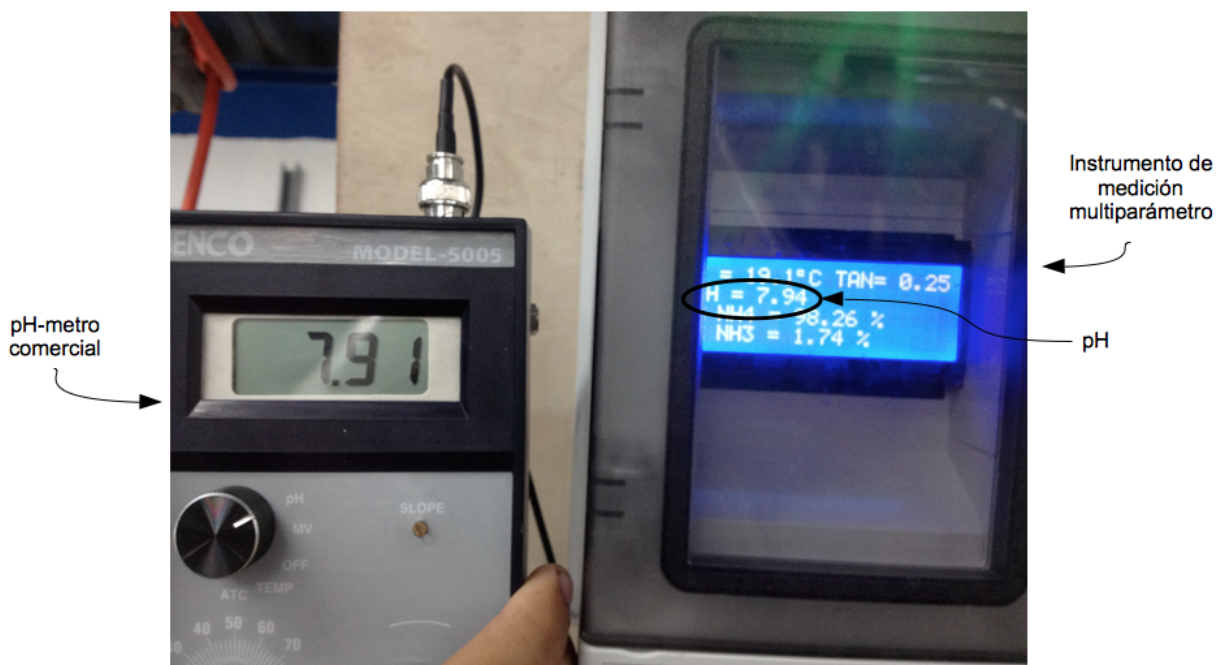
Figura 53: Comparación de mediciones de pH entre el dispositivo multiparámetro y un pH-metro comercial.
