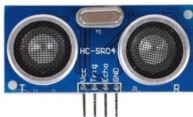
Figura 27: Sensor ultrasónico HC-SR04.
