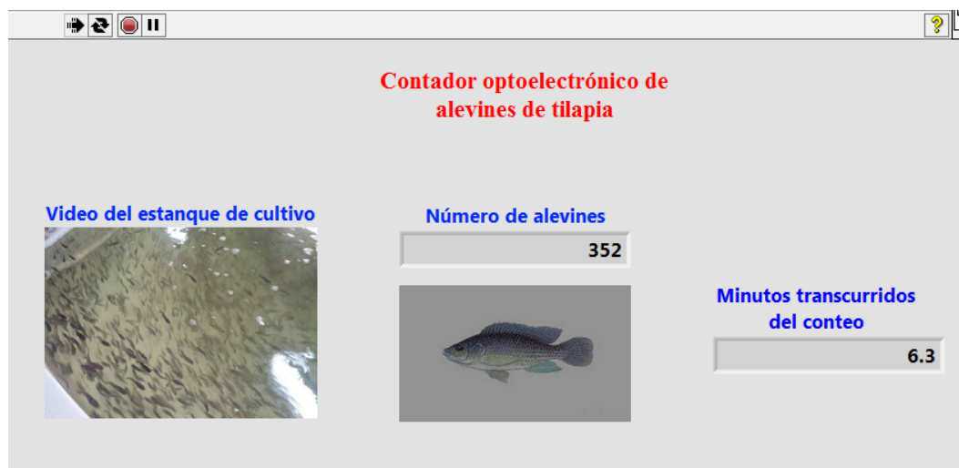
Figura 49: Panel frontal de la interfaz gráfica desarrollada en LabVIEW.
