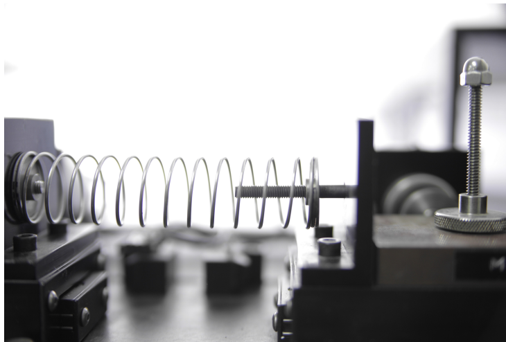
Figura 10. Holgura mecánica entre el resorte k_2 y la masa m_2 .
