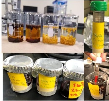
Figura 6. Preparación y análisis de hidrolizados de BSG y OP bajo distintas condiciones de hidrólisis ácida y medición de pH previa a la fermentación.
