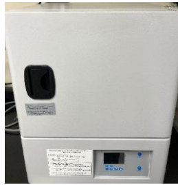
Figura 8. Incubadora empleada en la fermentación alcohólica para mantener condiciones controladas de temperatura y agitación durante la producción de bioetanol.
