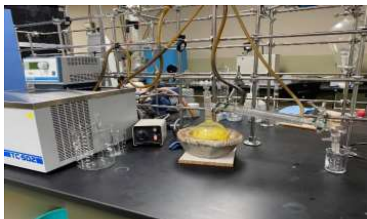
Figura 19. Equipo utilizado para pruebas de hidrodestilación de cáscara de naranja y toronja.
