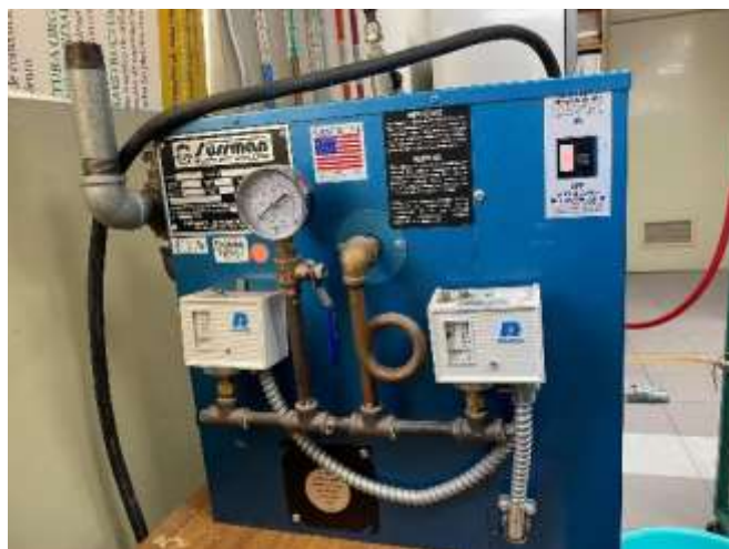
Figura 35. Equipo de extracción por arrastre de vapor de agua.
