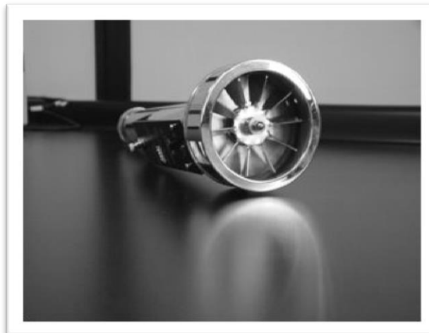
Figura 5. Muestreador RCS (Reuter Centrifugal Sampler).
