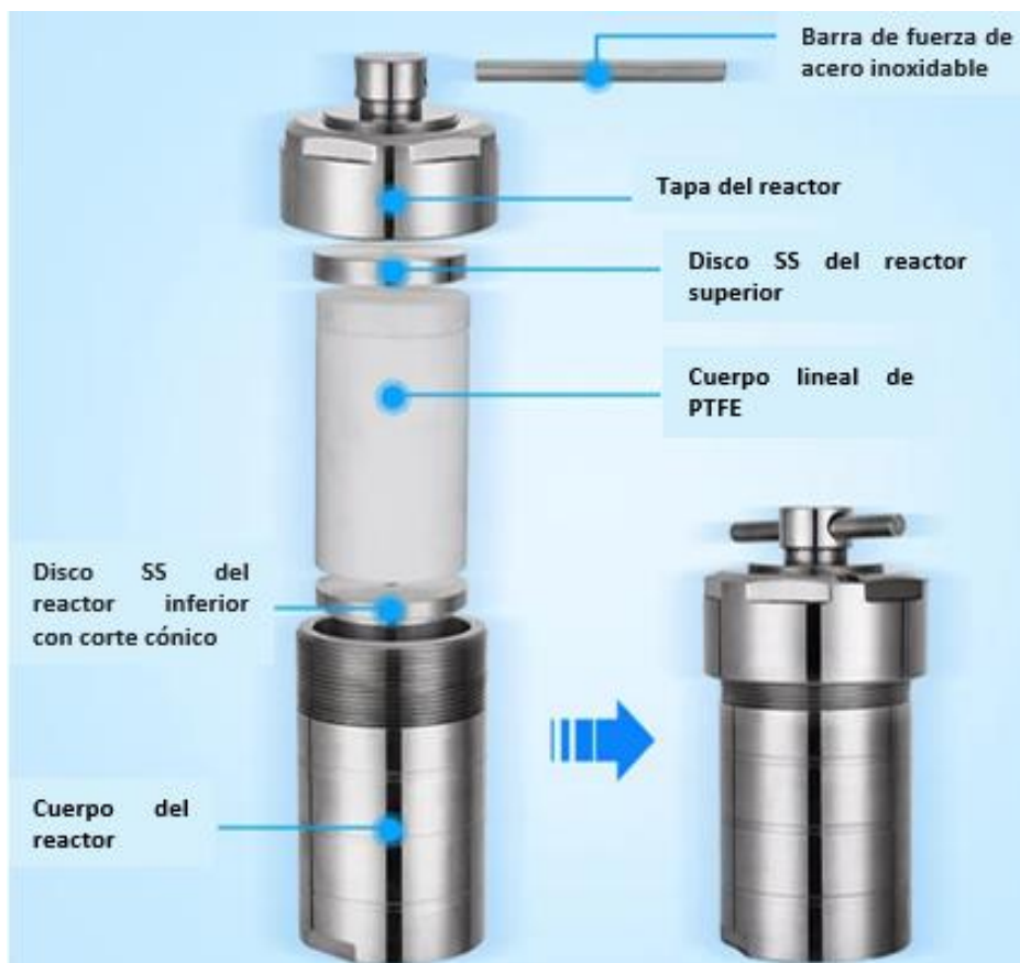
Figura 6.- Sistema autoclave para síntesis por método hidrotermal. Modificado de Toption & We, S.F.
