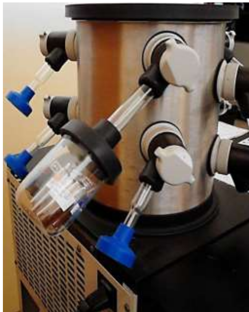
Fig. 7. Cristales de TMA, conservados en un liofilizador FreezeDrySystem/Freezone 4.5 LABCONCO
