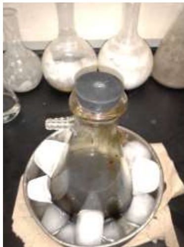
Fig. 4. Matraz conteniendo TMA, en baño de hielo
