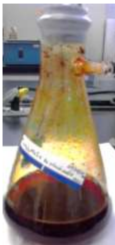
Fig. 9. Cristales de TMA inmerso en la solución madre.
