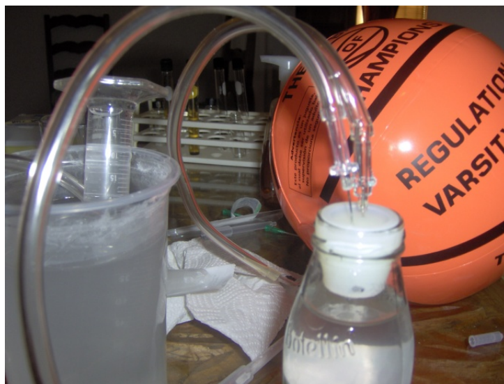
Figura 29. Detalle de la inserción de aguja de calibre grueso para burbujeo de nitrógeno en el medio de cultivo, al lado de una aguja para desalojar nitrógeno así como los gases desplazados al exterior (arriba). Un recipiente de plástico conteniendo nitrógeno fue conectado a la aguja de burbujeo a través de una manguera de plástico transparente (abajo).
