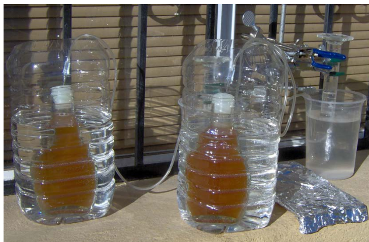
Figura 28. Reactor plano en un baño de temperatura controlada, durante la etapa de producción fotosintética de hidrógeno con luz solar.
