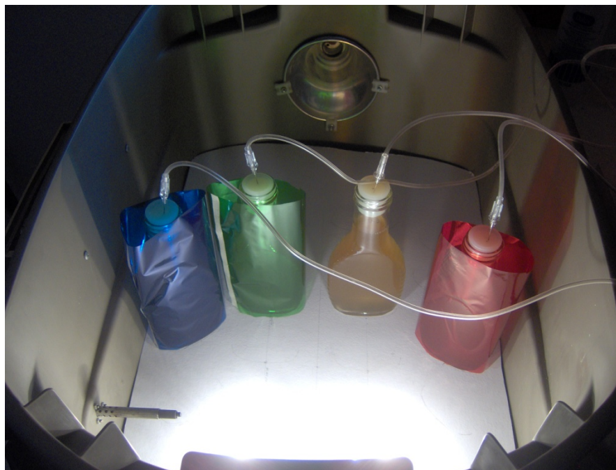
Figura 27. Interior de la incubadora con cuatro reactores de geometría plana, en posiciones con la misma intensidad luminosa incidente. La figura también muestra los filtros de colores utilizados en este estudio.
