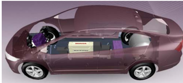
Figura 8. Automóvil Honda FCX Clarity, desplazado por un motor eléctrico que recibe energía de una celda de combustible de hidrógeno. Actualmente se ofrece en renta al público por $600 USD al mes [20].
