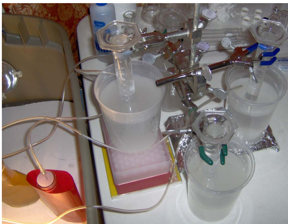
Figura 30. Vista general del acoplamiento del bio-reactor con el sistema de medición de hidrógeno para dos reactores (arriba) y para cuatro reactores (abajo). El líquido en la
