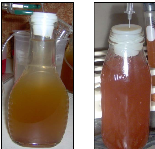
Figura 25. Reactores de vidrio utilizados para la generación de hidrógeno fotosintético. Reactor con geometría cilíndrica a la izquierda, reactor semiplano a la derecha.
