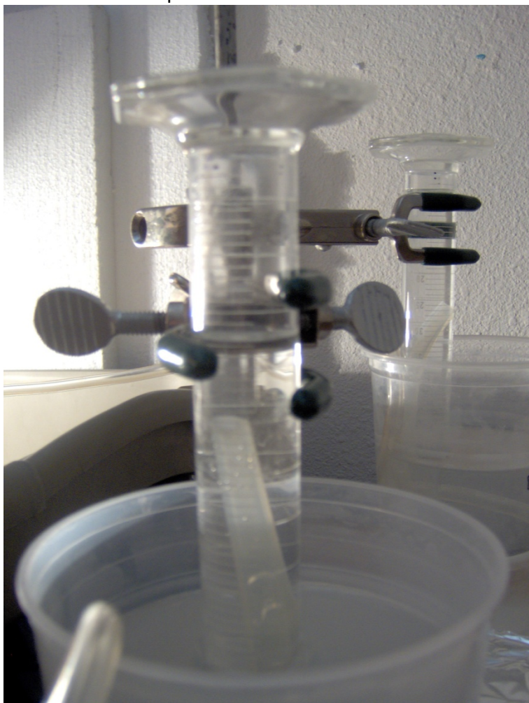
Figura 31. Detalle de la inserción de la manguera que conduce el biogás al interior del sistema medidor de hidrógeno.
