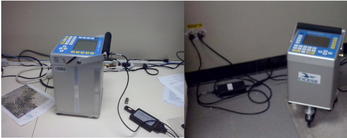
Figura 3-2. Gravímetro relativo CG-5 de Scintrex. Izquierda descarga de datos a memoria externa vía cable serial RBS; derecha gravímetro relativo CG-5 conectado a fuente de alimentación externa.
