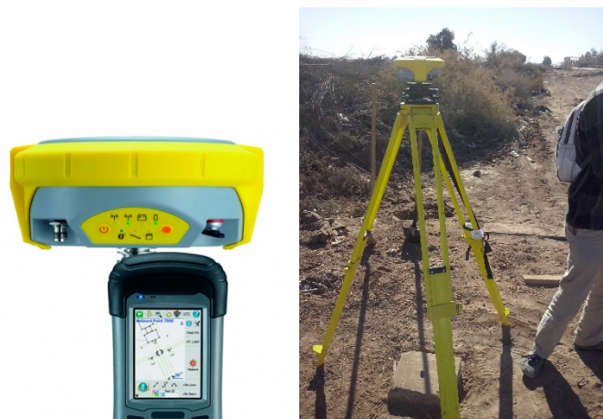
Figura 3-7. Equipo GPS Geomax Zenith25.
