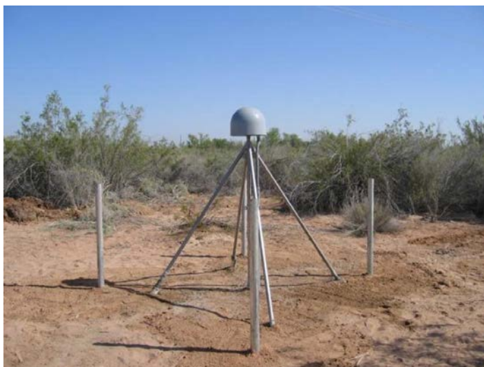
Figura 3-12. Estación geodésica P500 perteneciente a la red CORS.
