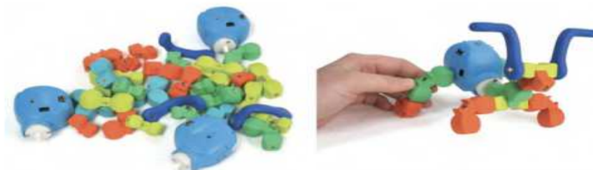
Figura 10. Topobo, consiste de partes móviles y conectables que son adheridas a una unión "activa" (la parte azul, ligeramente mayor) que puede registrar y reproducir los movimientos de las partes adheridas.
