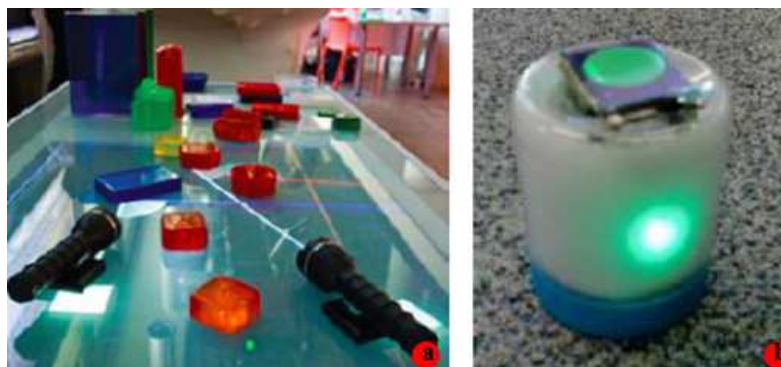
Figura 14. (a) La mesa tangible interactiva. (b) Un objeto aumentado con Led y acelerómetro.
