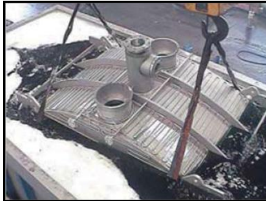
Figura 2.31 Decapado por inmersión en tanque
