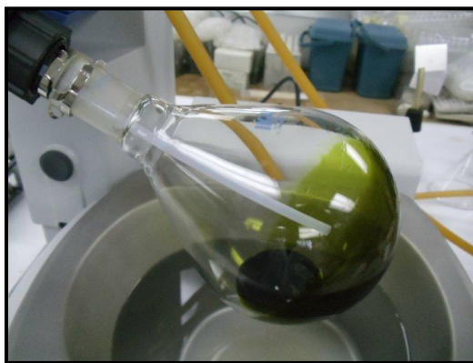
Figura 3.1 Destilación al vacío de extracto etanólico de Pachycormus discolor .
