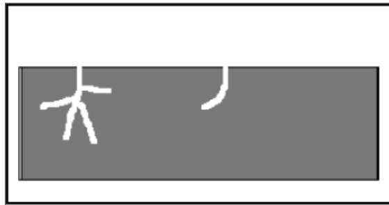
Figura 2.4 Corrosión por fisuras.
