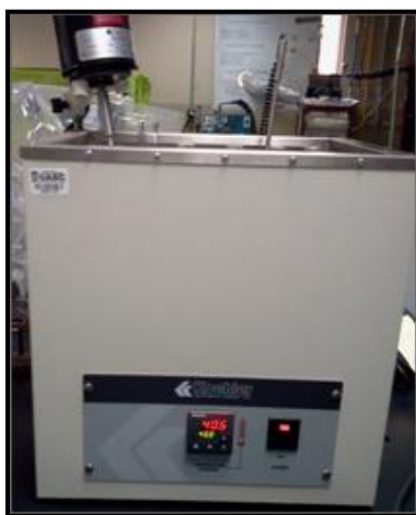
Figura 3.4 Baño de temperatura constante con un microprocesador de control de temperatura.
