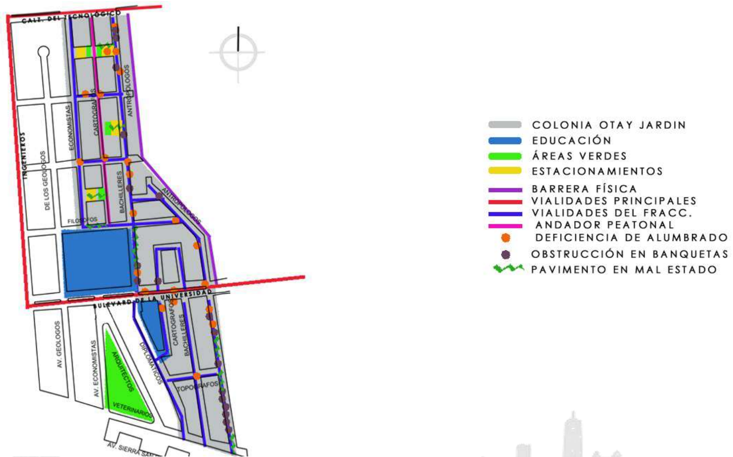
ILUSTRACIÓN 7.0.6 DEFICIENCIAS DE INFRAESTRUCTURA
