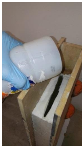
Figura 2.19. Inyección de resina cristalina en molde de silicón.
