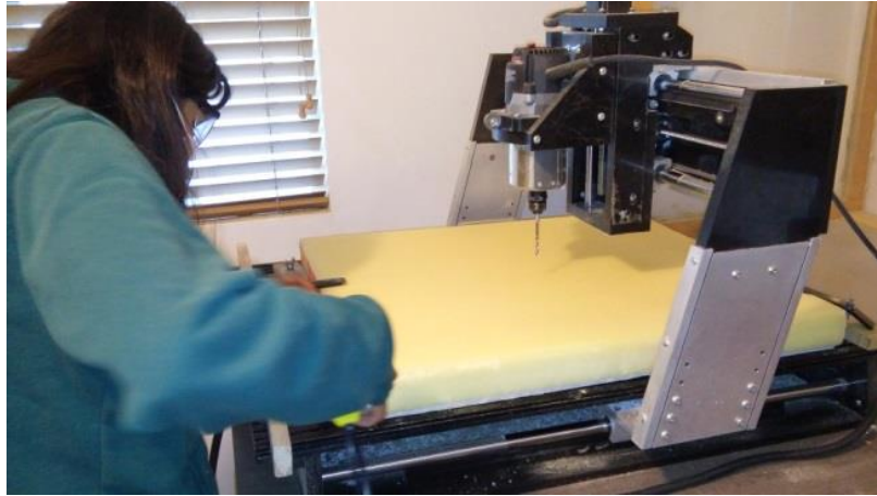
Figura 2.3. Placa de espuma de policarburo instalada en la CNC.
