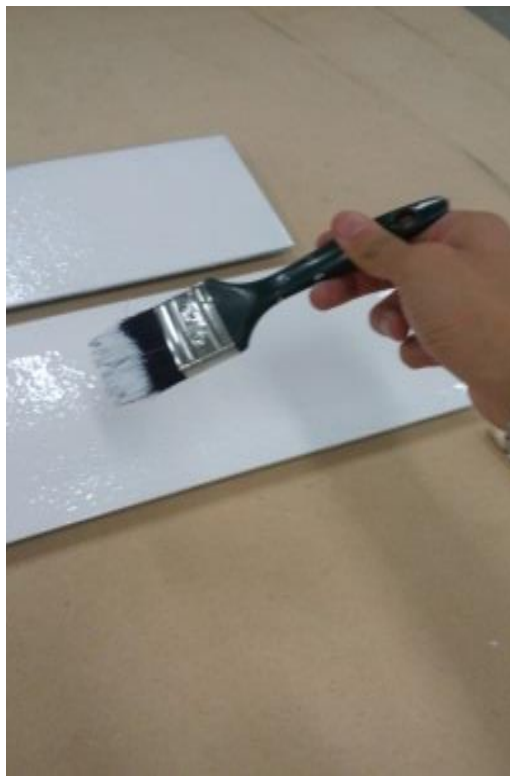
Imagen 8. Aplicación de gelcoat sobre el ala con una brocha.
