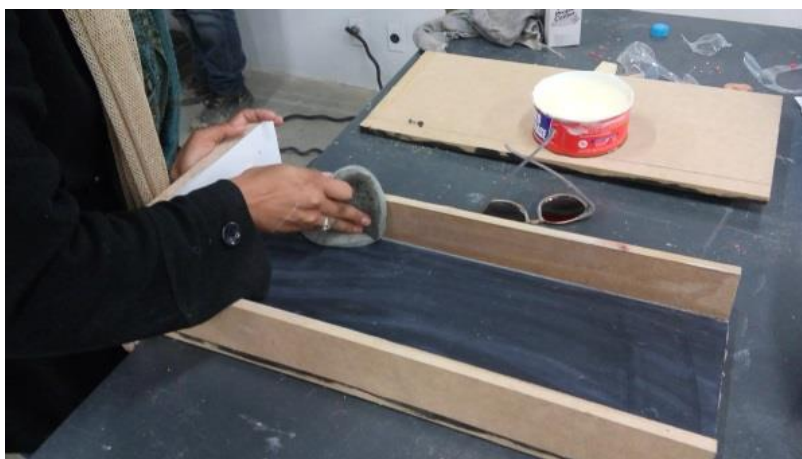
Imagen 11. Aplicación de desmoldante en caja de madera.
