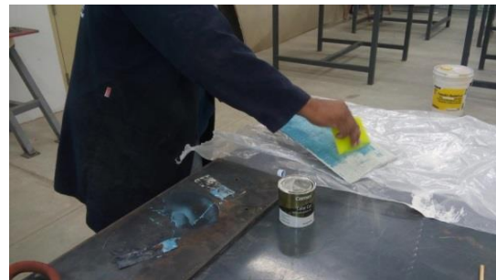
Figura 2.9. Aplicación de bondo con cuña de hule: (A) Aplicación inmediata de bondo, (B) Aplicación de manos delgadas uniformes de bondo.
