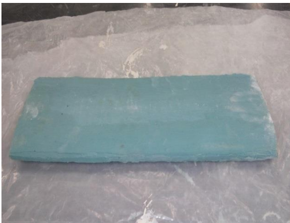
Imagen 7. Ala lista para lijado: (A) Ala con imperfecciones después de secado, (B) Último lijado para un mejor acabado.
