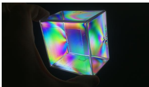
Figura 1.1. Modelo fotoelástico birrefringente.
