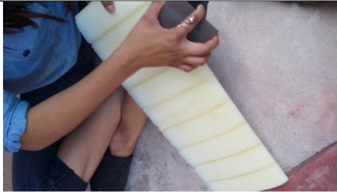
Imagen 3. Lijado del modelo para un mejor acabado.
