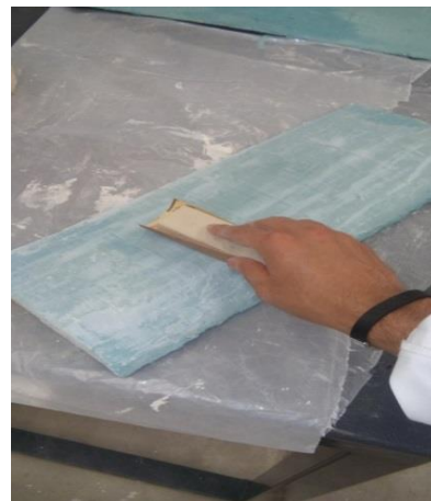
Imagen 7. Ala lista para lijado: (A) Ala con imperfecciones después de secado, (B) Último lijado para un mejor acabado.
