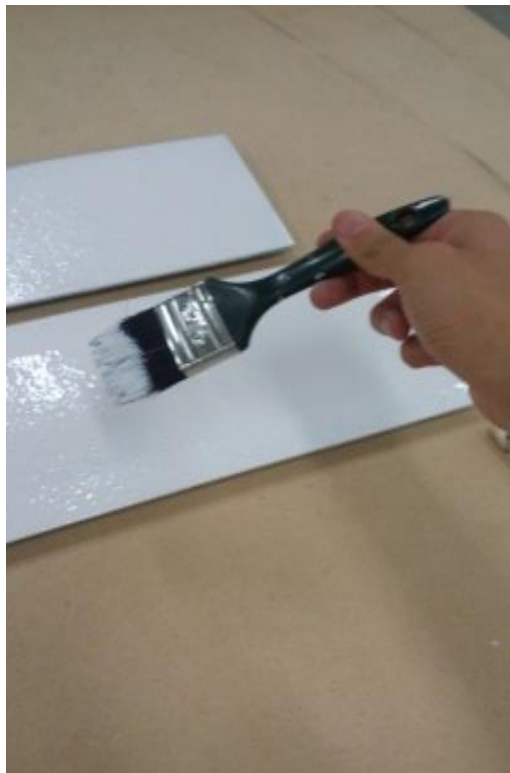
Figura 2.11. Aplicación de gelcoat sobre el ala con una brocha.
