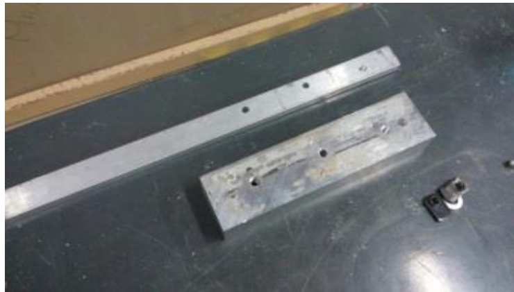
Figura 3.10. Brazo de palanca con tres agujeros coincidentes a la barra de sujeción.
