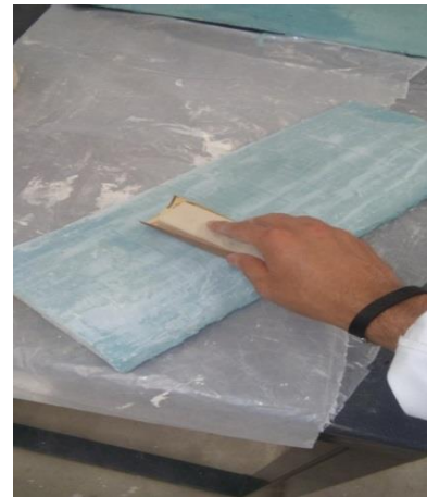
Figura 2.10. Ala lista para lijado: (A) Ala con imperfecciones después de secado, (B) Último lijado para un mejor acabado.
