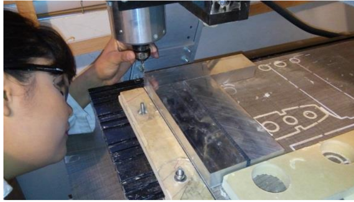
Figura 3.7. Centrado de cortador a la placa de aluminio.
