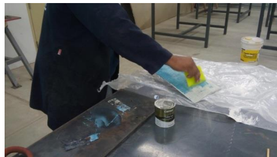
Imagen 6. Aplicación de bondo con cuña de hule: (A) Aplicación inmediata de bondo, (B) Aplicación de manos delgadas uniformes de bondo.
