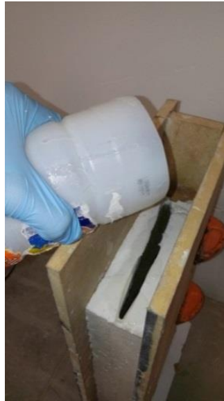
Imagen 16. Inyección de resina cristalina en molde de silicón.
