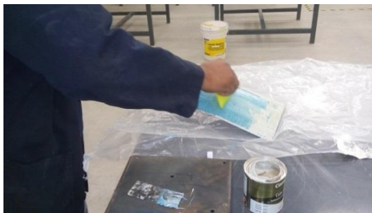
Imagen 6. Aplicación de bondo con cuña de hule: (A) Aplicación inmediata de bondo, (B) Aplicación de manos delgadas uniformes de bondo.
