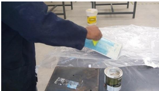
Figura 2.9. Aplicación de bondo con cuña de hule: (A) Aplicación inmediata de bondo, (B) Aplicación de manos delgadas uniformes de bondo.
