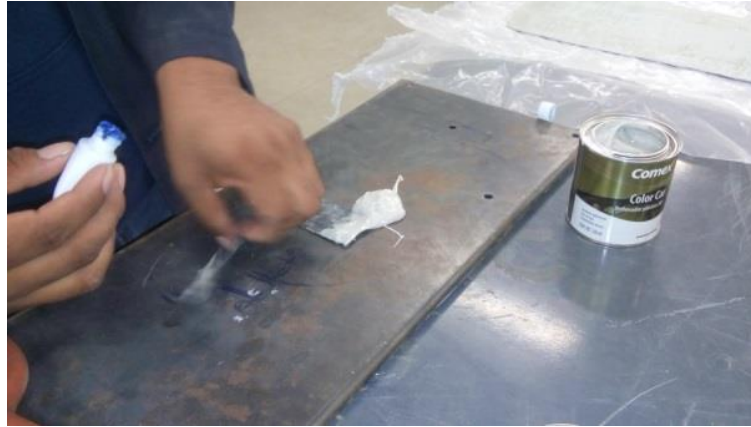
Figura 2.8. Mezcla de color car relleno plástico con 2% de catalizador.
