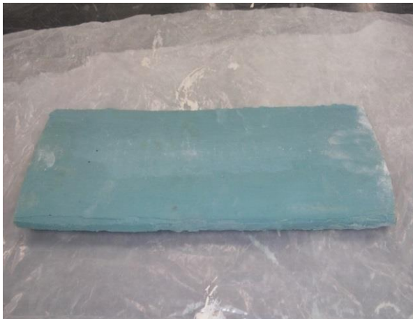
Figura 2.10. Ala lista para lijado: (A) Ala con imperfecciones después de secado, (B) Último lijado para un mejor acabado.
