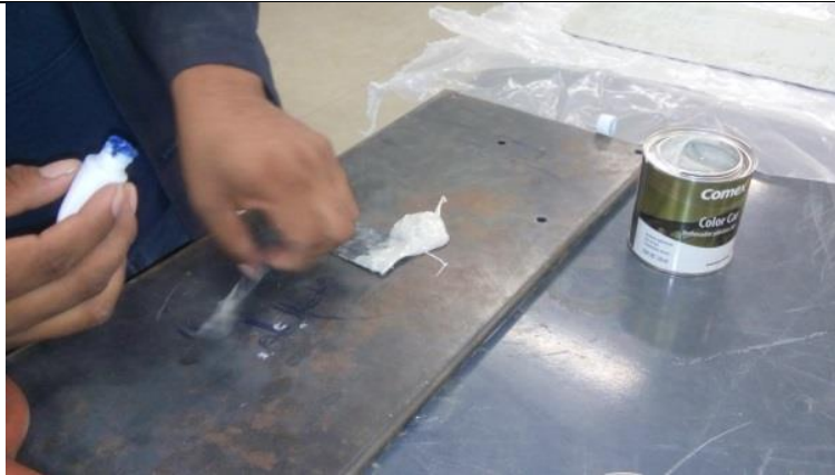
Imagen 5. Mezcla de color car rellenador plástico con 2% de catalizador.
