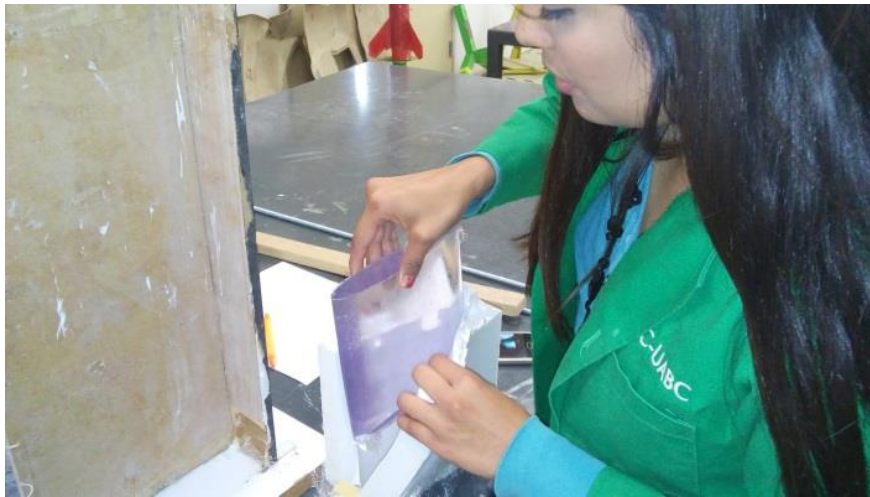
Figura 2.20 Extracción del ala del molde de silicón.
