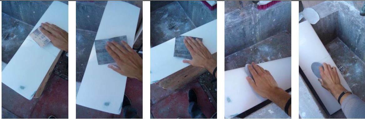
Imagen 9. Lijado en agua el ala con gelcoat: (A) Lija grado 100, (B) Lija grado 400, (C) Lija grado 600, (D) Lija grado 1200, (E) Lija grado 2000.
