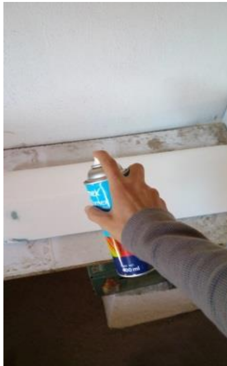
Imagen 10. Aplicación de esmalte acrílico transparente al ala.
