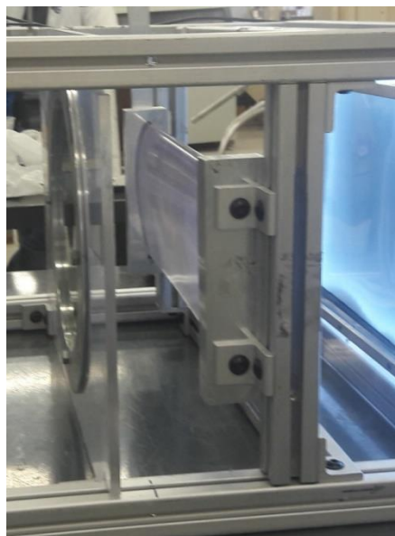
Figura 3.11. Modelo foto elástico fijo al banco de pruebas.
