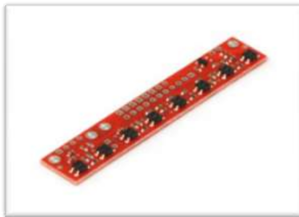
Figura 12. Tablero con 8 sensores infrarrojos.
