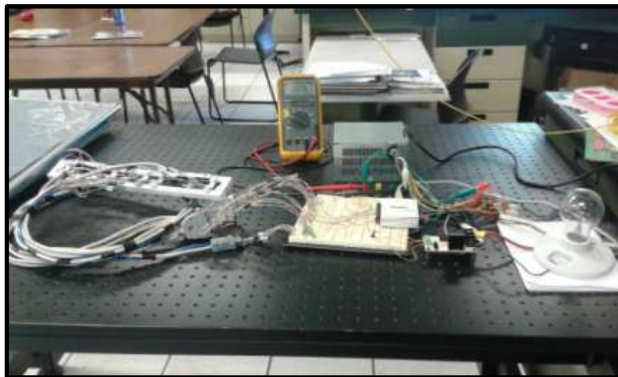
Figura 40. Sistema de detección de fallas infrarrojo (SDFI).
