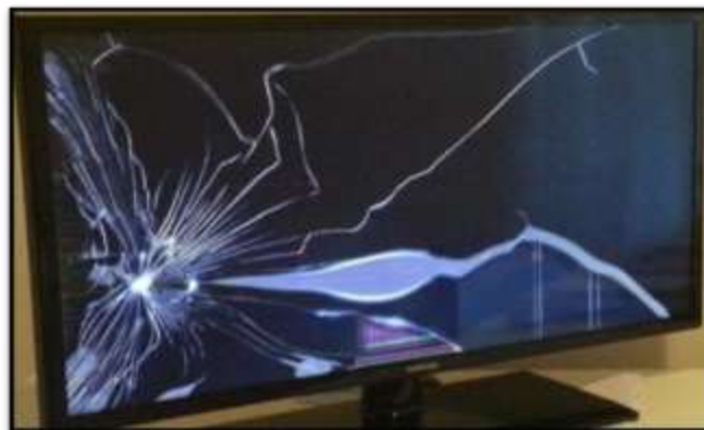
Figura 20. Pantalla con daño interno evidente al energizarse la misma.
