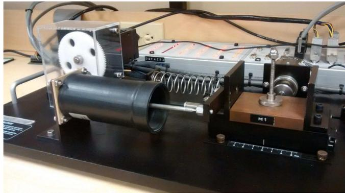
Figura 19. Sistema Masa Resorte Amortiguador
