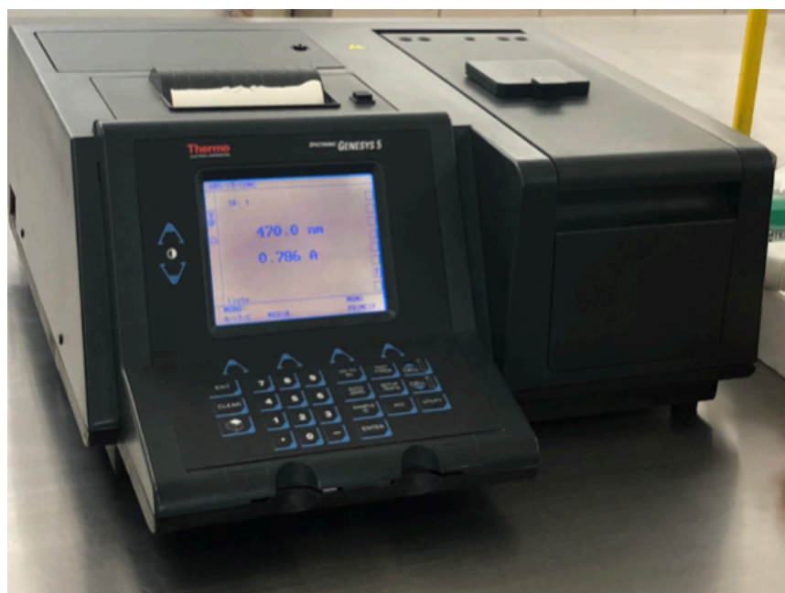
Figura 18: Espectrofotómetro calculando la concentración aproximada a 8 \times 10^6 UFC/ mL.
