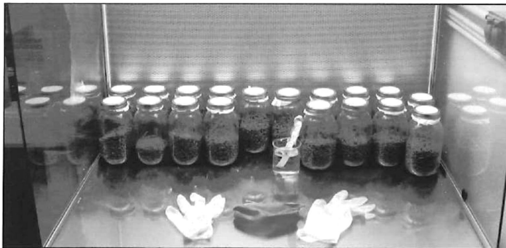
Figura 8. Los frascos y el material en la campana de flujo laminar por 6 horas con luz UV para la desinfección de todo el ambiente de la campana.
