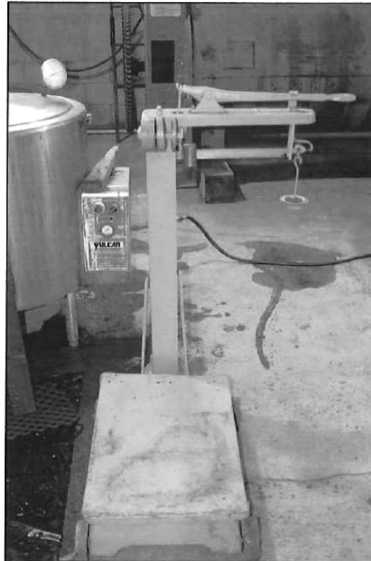
Figura 25. Báscula industrial usada para pesar la fibra para formar los paquetes de 10 kg.
