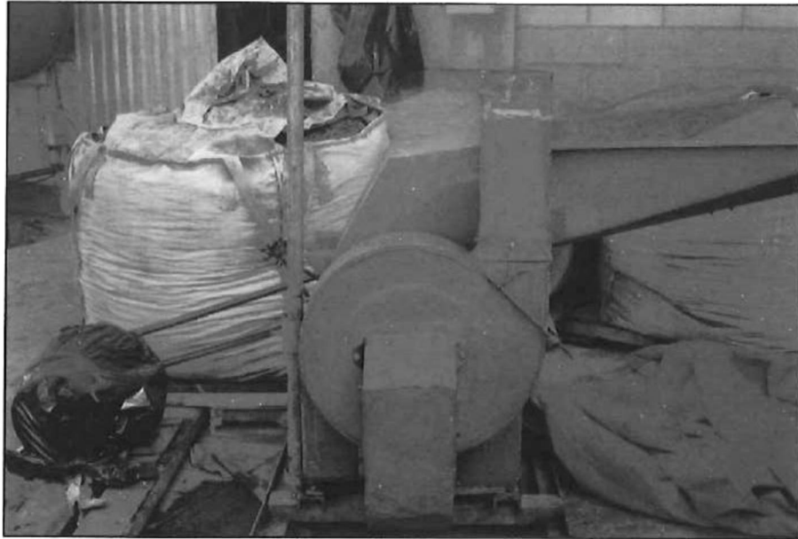
Figura 20. Molino industrial usado para la molienda de la paja.
