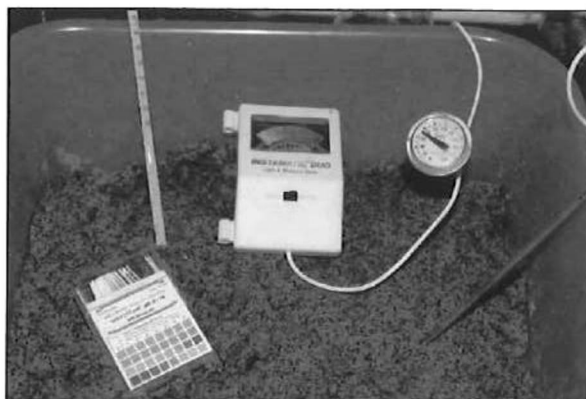
Figura 13. Se observa la medición de los parámetros fisicoquímicos del sustrato por medio de dos termómetros, papel pH e higrómetro.
