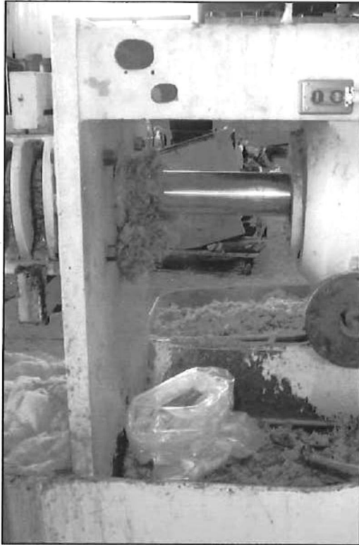
Figura 24. Prensa para la extracción de jugo de yuca fresca de donde sale la fibra la cual se calentó a 60 °C y fue puesta en las bolsas directamente.
