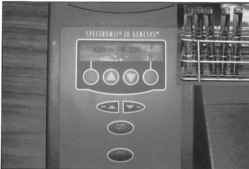
Figura 32. Espectrofotómetro usado para la cuantificación de carbohidratos y los tubos con diferentes concentraciones utilizados para la curva de calibración. Donde el primero a la izquierda es el blanco y va aumentando la concentración.
