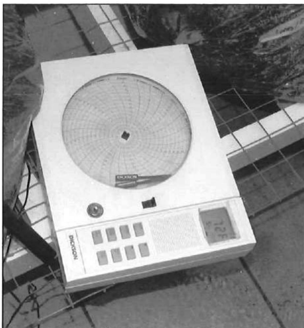
Figura 19. Higrómetro y termómetro DICKSON usados para medir los parámetros ambientales del cuarto de cultivo.
