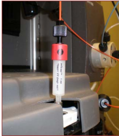
Figura 20. Columna de interacción hidrofóbica, pre-empacada con 1 mL de resina Phenyl Sepharose 6 fast flow.
