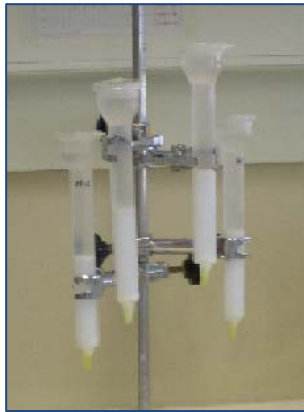
Figura 10. Arreglo experimental de columnas cromatograficas empacadas con Phenyl Sepharose 6 fast flow, operadas por gravedad.
