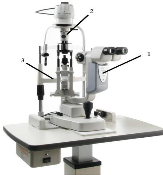
Figura 4.1.: Imagen de un biomicroscopio convencional cuyos componentes principales son: (1) brazo óptico, (2) brazo de iluminación y (3) marco de posicionamiento del paciente.
