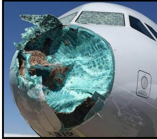
Figura 3.8. Daño causado a aeronave A319 por tormenta de granizo durante su vuelo [44].
