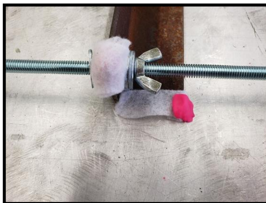
Figura 4.39. Protecciones aplicadas a fixtura para no dañar la bolsa de vacío.
