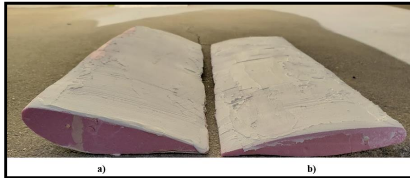
Figura 4.28. Perfiles con aplicación de resanador, a) GOE777-IL, b) SC (2)-0714.
