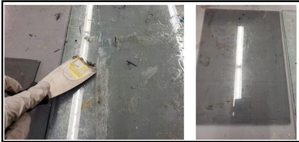
Figura 4.11. Superficie para laminado, a) antes de limpieza, b) posterior a limpieza.
