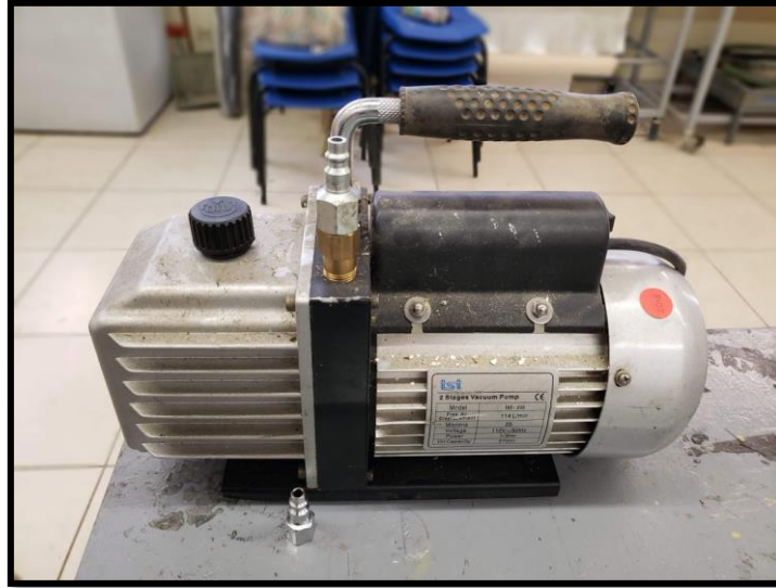
Figura 4.1. Bomba de vacío utilizada para el curado de laminados y perfiles alares.
