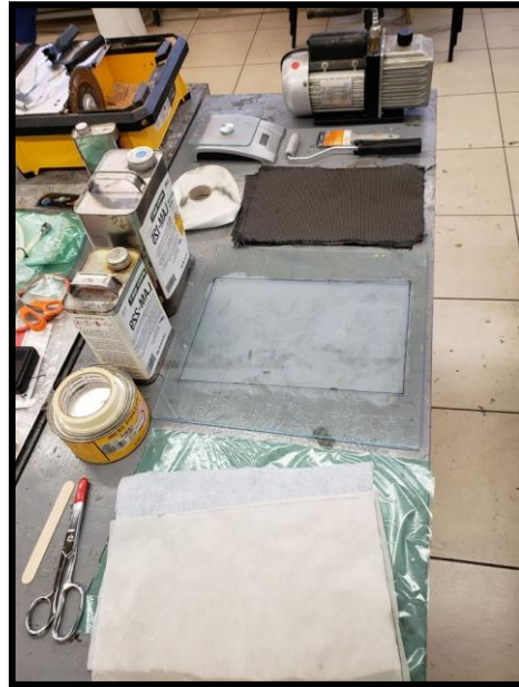
Figura 4.13. Materiales, equipo y herramientas para laminado con aplicación de vacío, de abajo hacia arriba, 1) bagging film (café), 2) breather (blanca), 3) release peel ply (verde).
