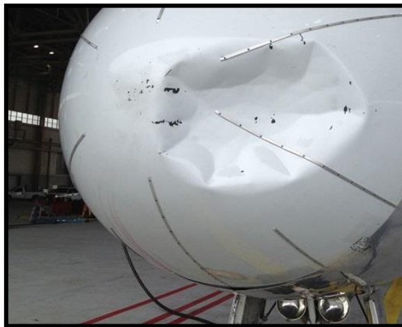
Figura 3.6. Daño causado en fuselaje por impacto de ave [43].
