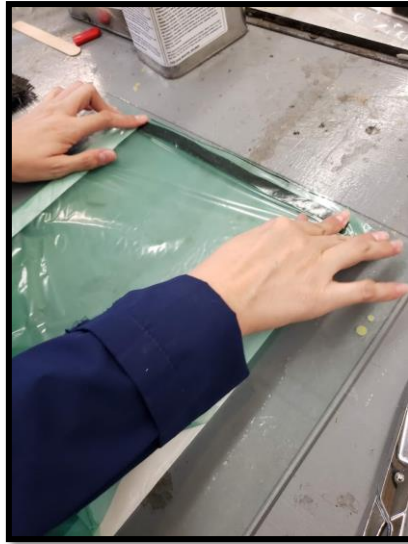
Figura 4.14. Adhesión de cinta doble cara en superficie y bolsa de vacío para proceso de vacío.
