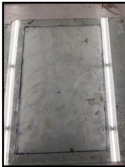
Figura 4.12. Superficie para laminado, a) aplicación de cera desmoldante, b) superficie con 5 capas aplicadas.
