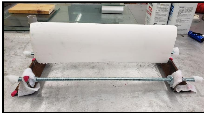
Figura 4.38. Colocación de molde GOE777-IL en fixtura para manufactura.
