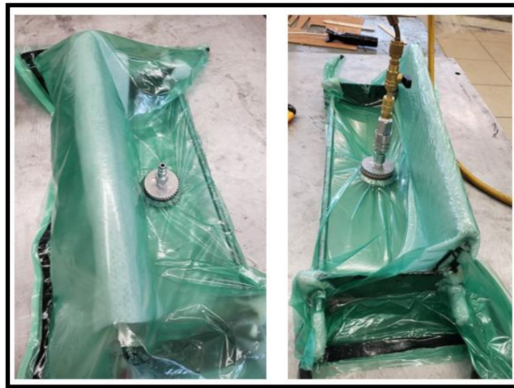
Figura 4.41. Mejora en bolsa de vacío, a) bolsa sellada antes de aplicar vacío, b) bolsa con vacío aplicado.
