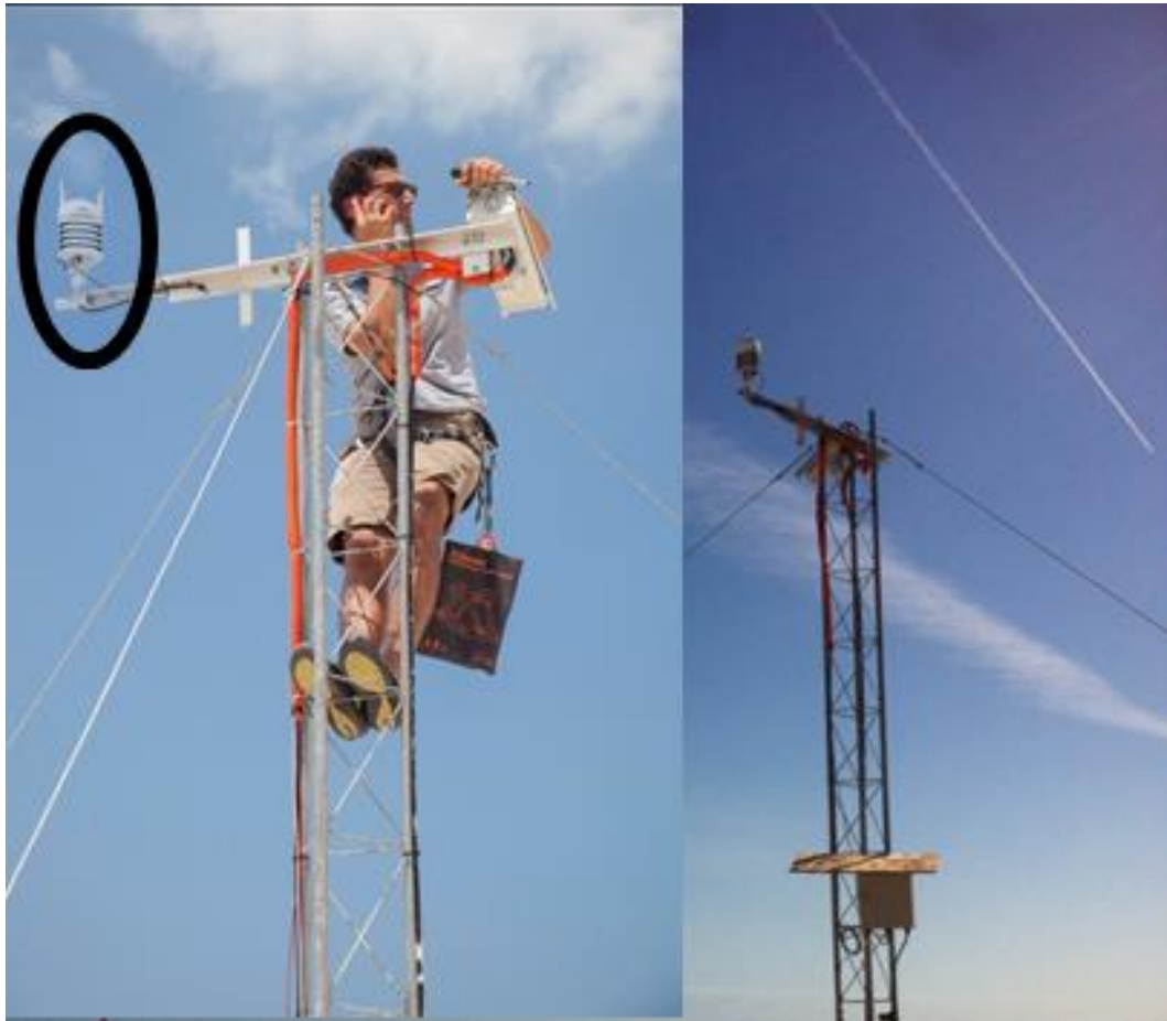
Figura 8. Torre de aluminio colocada en la playa supramareal donde se colocó la estación meteorológica.
