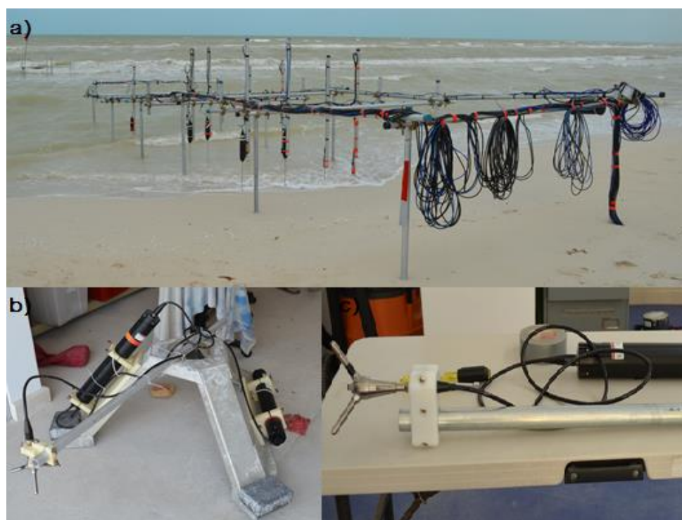
Figura 7. Instrumentación utilizada para la colección de datos hidrodinámicos. a) En la zona de swash en un anclaje tipo andamio conformado con tubos de aluminio. b) Anclaje con un Vector colocado sobre la barra somera en los transectos del este y oeste. c) Correntímetro Vector colocado en el transecto central, en un anclaje de aluminio similar al de la zona de swash pero de reducido tamaño.
