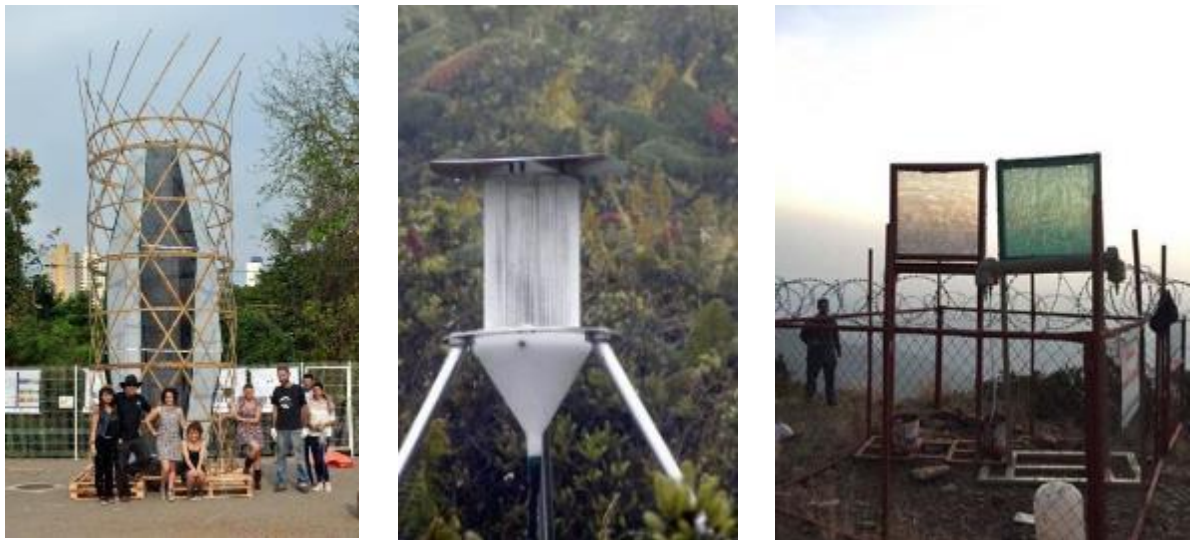
Nota. 1) Atrapanieblas cilíndrico. 2) Atrapanieblas cilíndrico, 3) Atrapaniebla rectangular. Fuente: Regalado & Ritter, 2019
