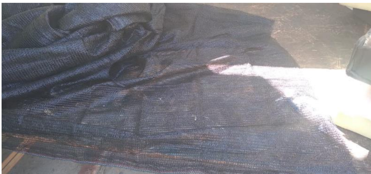
Figura 37. Malla para neblinómetro
