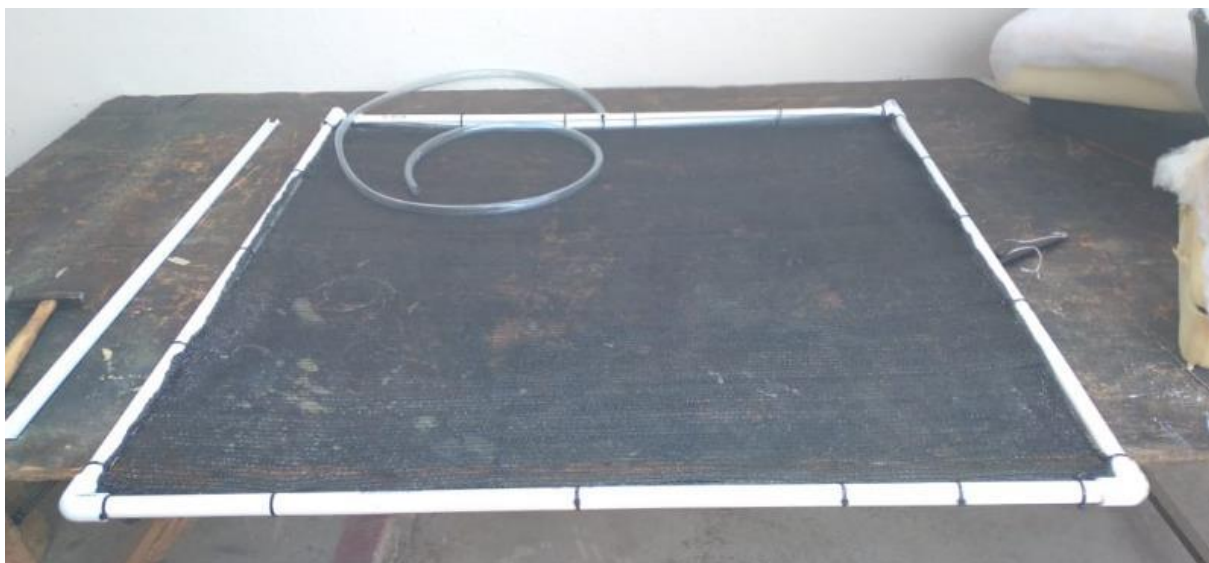
Figura 38. Marco de neblinómetro con estructura de PVC de ½”
