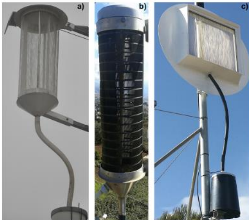
Figura 18. Tipos de atrapanieblas utilizados en el experimento de Regalado & Ritter (2019)
