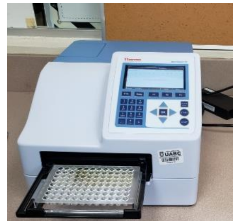
Imagen 27. Lector de microplaca Thermo
