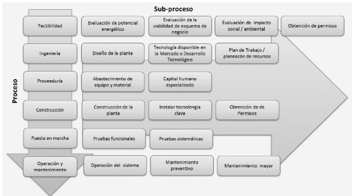
Figura 3.4. Esquema de la cadena de valor de generación de energía eléctrica a partir de energías limpias.
