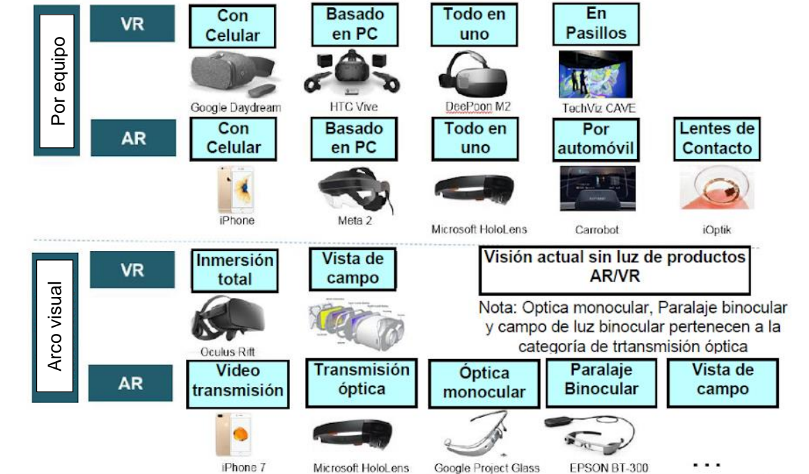
Figura 12: Tipos de inmersión de VR / AR por dispositivo y por percepción visual.
