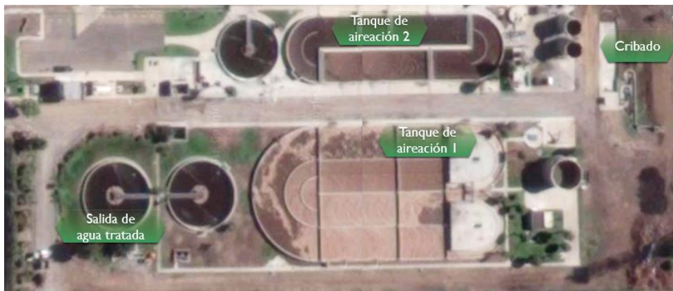
Figura 15. Localización de los puntos de muestreo en la PTAR "Rosarito Norte", Google maps.
