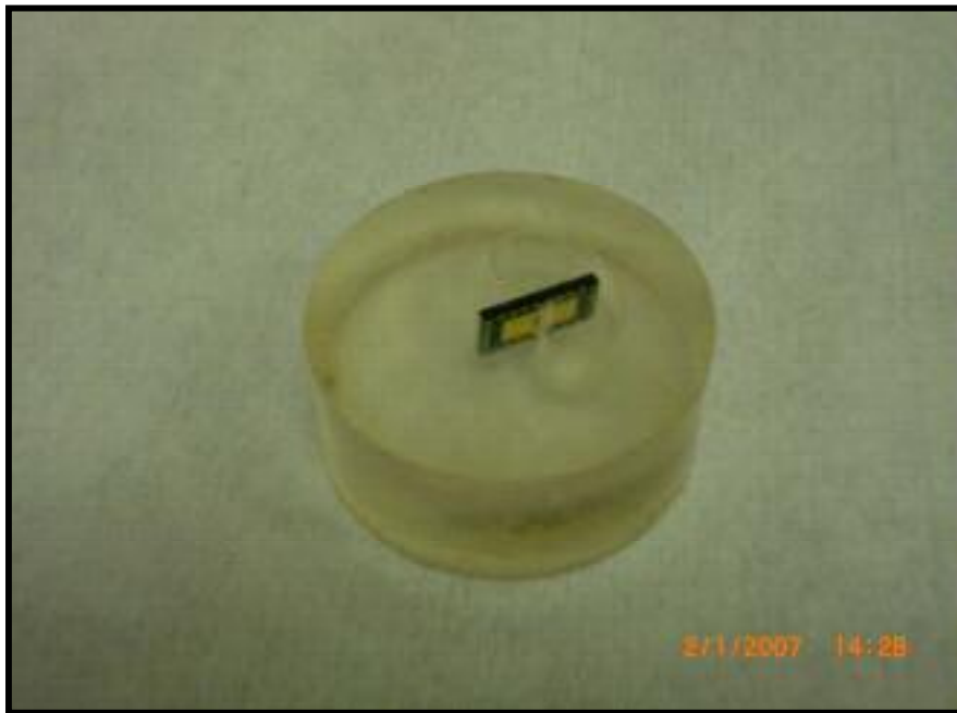
Figura 2.7. Muestra suspendida en resina epóxica.
