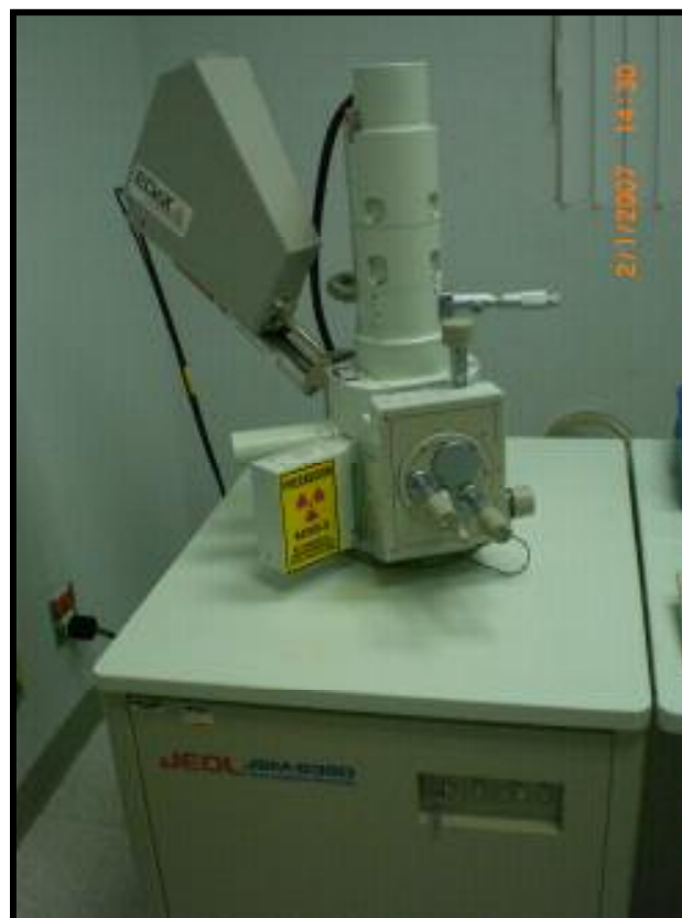
Figura 2.9. Equipo de microscopía electrónica de barrido y análisis de energía dispersiva de rayos-x
