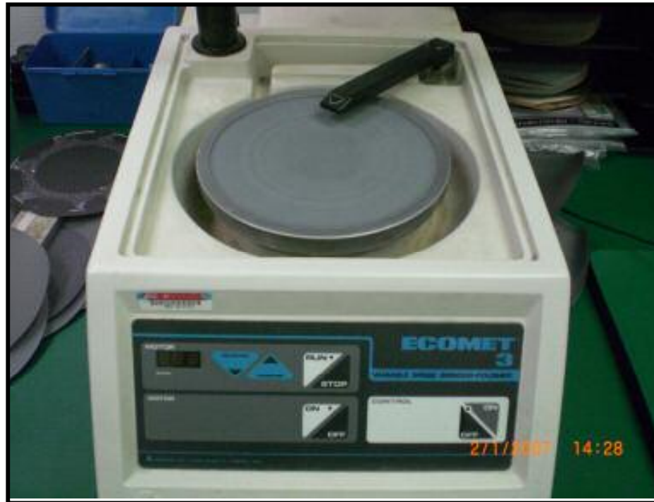
Figura 2.8. Equipo de rebajado manual.
