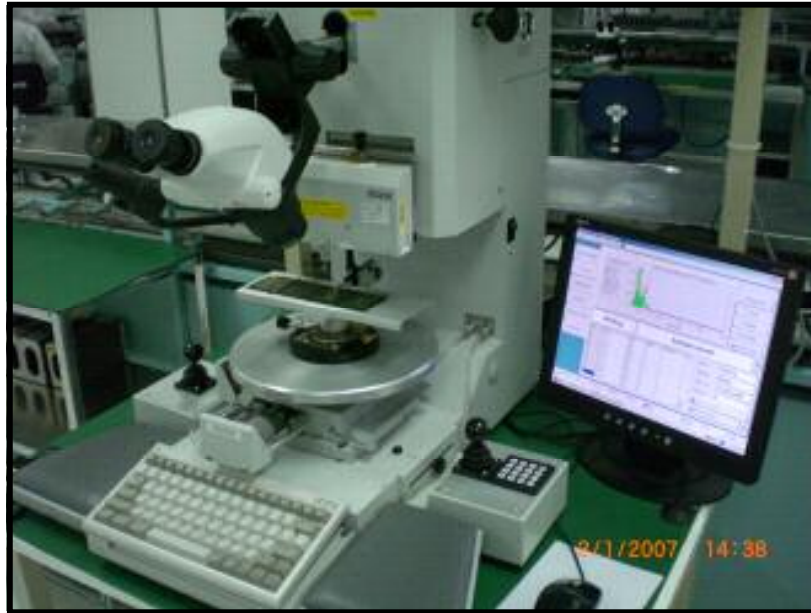
Figura 2.4. Equipo de medición de fuerza de soldado DAGE4000
