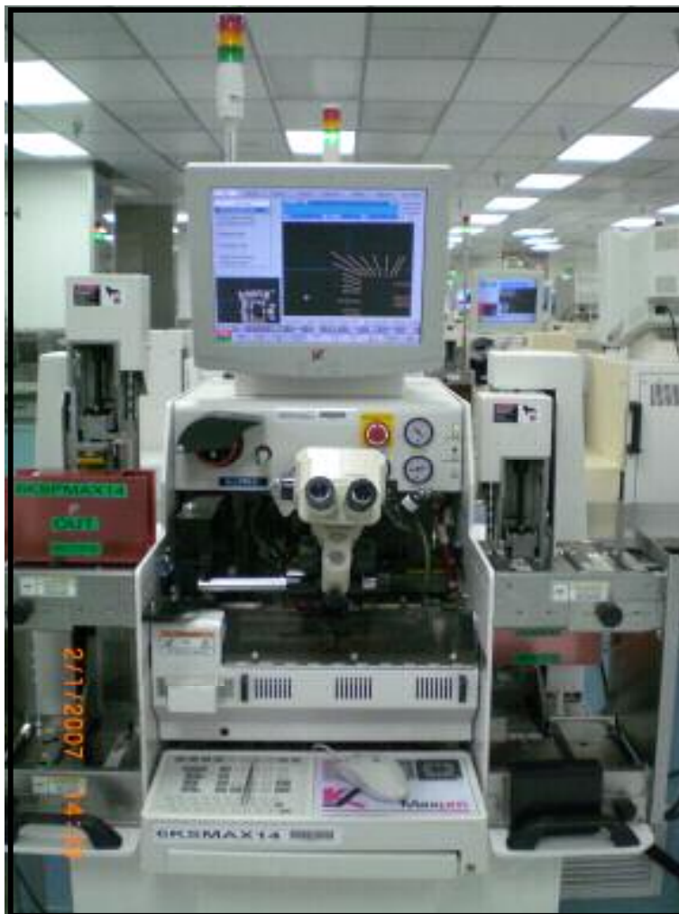
Figura 2.2. Equipo automático de soldado de microcircuitos.
