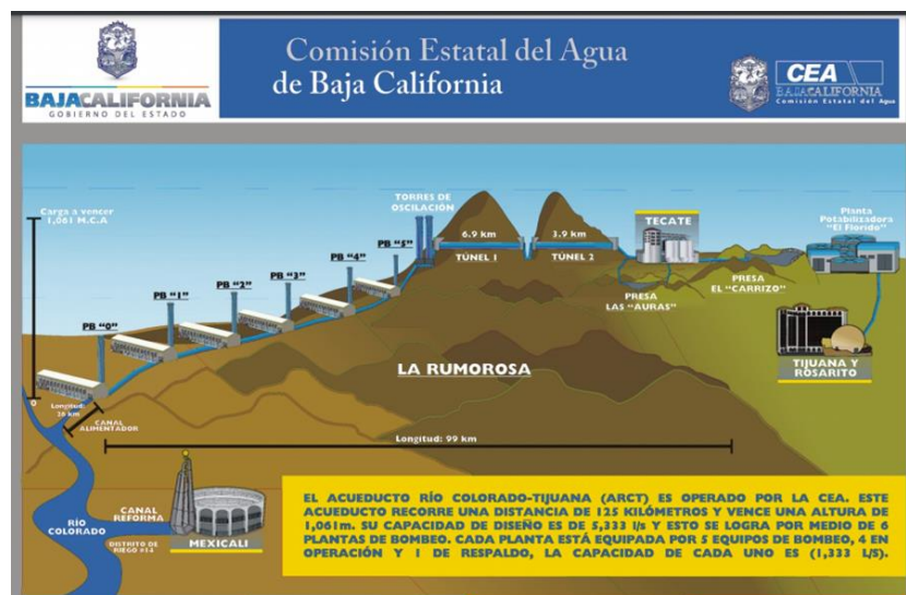
Figura 26. Recorrido del Acueducto Río Colorado-Tijuana
