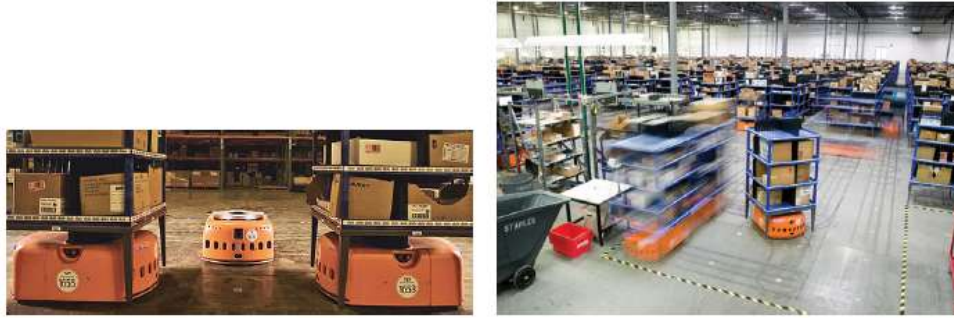
Figura 4.27: Robots de Kiva Systems (Izquierda) e Robots puesto en marcha en instalaciones en Denver (derecha) donde los robots realizan trabajos de almacén.
