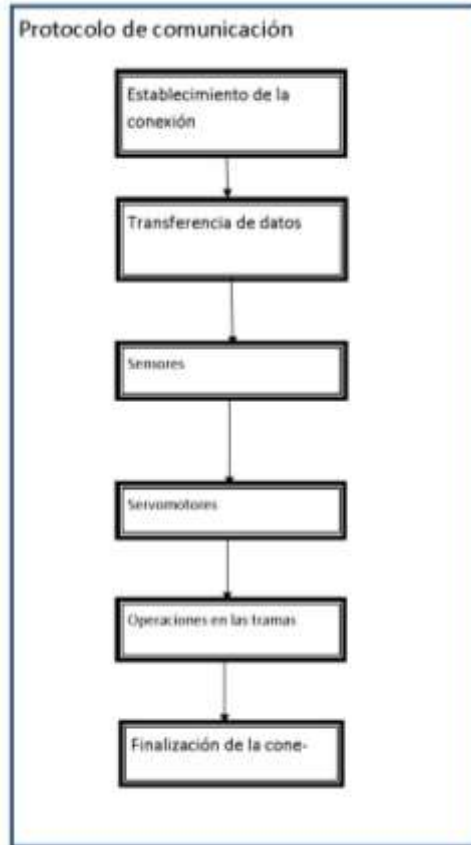
Figura 4.13: Servicios de comunicación del robot EV3
