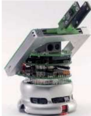
Figura 2.10: Robot con estructura diferencial. (Robot Khepera)
