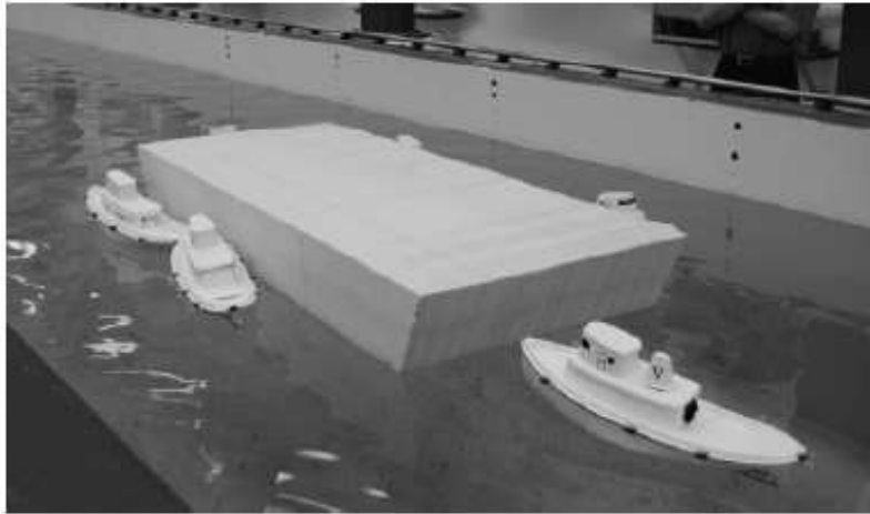
Figura 4.28: Seis barcos autónomos remolcando de manera coordinada una barcaza simulada
