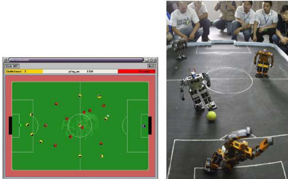
Figure 4.29: Simulador Soccer Server empleado en la competencia RoboCup (izquierda) e instantes de un partido de una competencia organizada por la FIRA (derecha)
