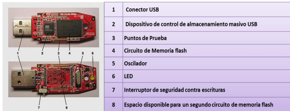
Fig. 1-6: Componentes de una memoria flash.
