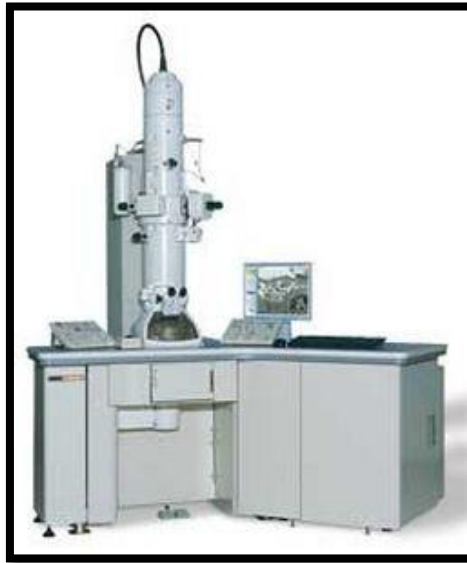
Fig. 4-31: TEM modelo JEM-2010 utilizado para el análisis estructural.
