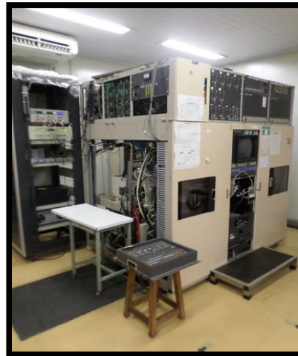
Fig. 4-11: Equipo de sputtering ULVAC system MCH-9000, utilizado para metalizar las muestras con aluminio.
