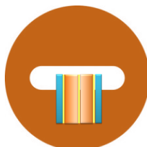
Fig. 4-30: Rejilla de ranura para TEM donde se colocó la muestra adelgazada.
