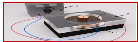
Figura 1. Montaje experimental del agitador MHD. 1 {ferrita rectangular imán permanente; 2 {contenedor de plexiglás; 3 {electrodo exterior; 4 {electrodo interno; 5 {suministro de energía. Imagen tomada de Ref. [1].
