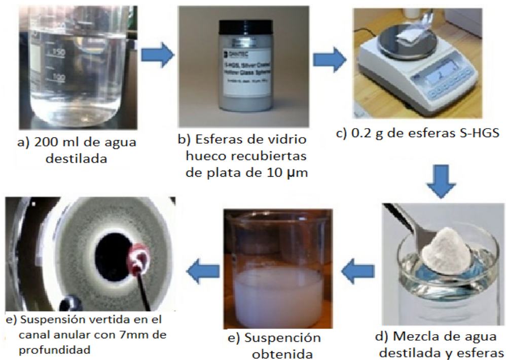
Figura 4.2: Proceso de sembrado de partículas.
