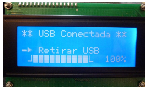
Figura 76. Visualización en LCD de 'Retirar USB'.
