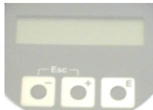
Figura 38. Botones de presionar del medidor de caudal electromagnético.
