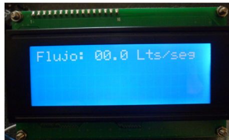
Figura 62. Visualización de flujo en LCD.
