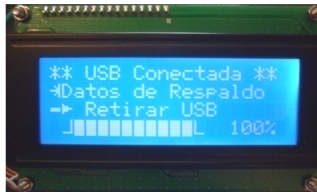
Figura 79. Visualización de avance de envío de datos de respaldo.
