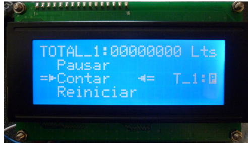
Figura 74. Configuraciones para totalizadores.
