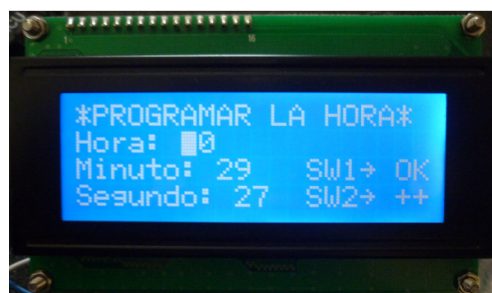
Figura 71. Visualización de modificar hora en LCD.
