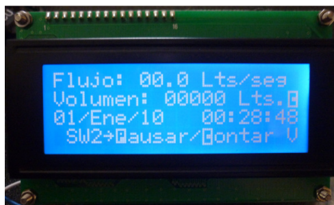
Figura 65. Visualización de flujo, volumen, fecha y hora en LCD.
