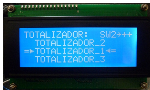
Figura 73. Visualización de totalizadores en LCD.
