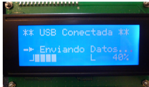
Figura 75. Visualización en LCD del envío de datos a USB.
