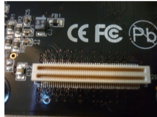
Figura 23. Conector de 100 terminales del módulo.
