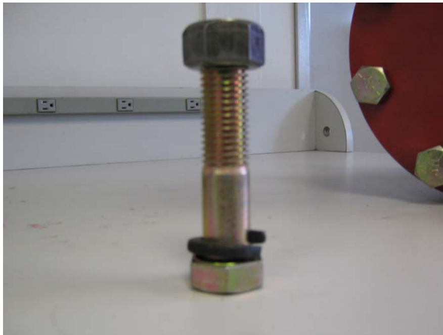
Fig. 4.10.- Perno 5-CA - Ti_6Al_4V seleccionado
