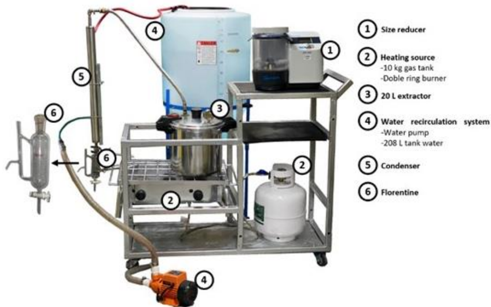
Figura 9. Sistema de extracción
